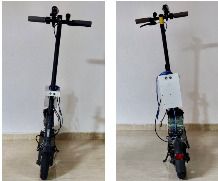
Figura 23 Vista frontal y posterior patinete eléctrico instrumentado. Fuente: Elaboración propia.
