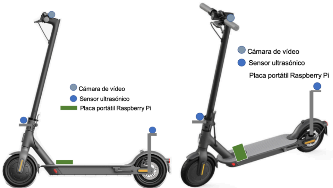
Figura 9 Esquema de montaje del vehículo instrumentado. Fuente: Elaboración propia.
