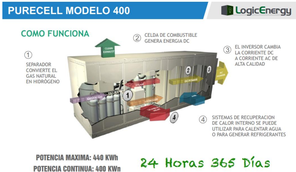
Figura 16: Esquema funcionamiento pila PureCell 400
