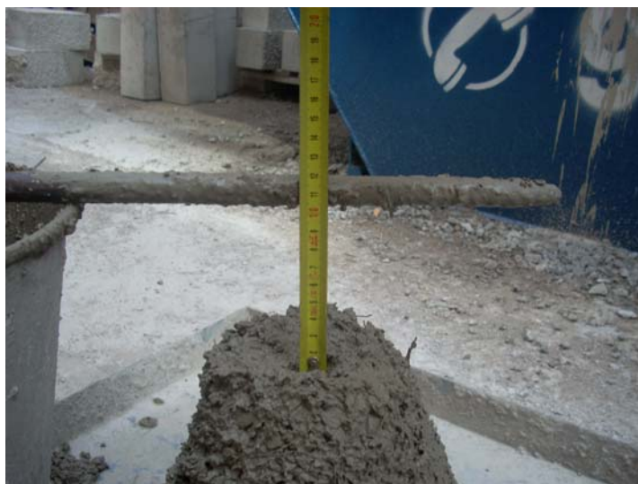
Figura 3.6 PRUEBA DEL CONO DE ABRAMS. 10.5 CM DE ASIENTO
