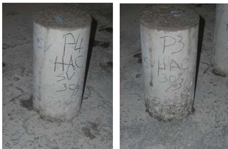
Figura 3.2 PROBETA 4 y 3, DE HAC, SIN VIBRAR
