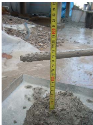
Figura 3.3 PRUEBA DEL CONO DE ABRAMS. 14.5 CM DE ASIENTO.
