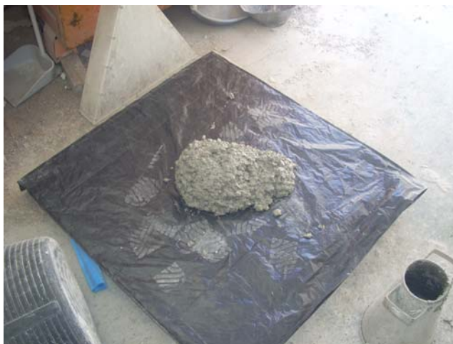
Figura 3.4 PRUEBA DE ESCURRIMIENTO
