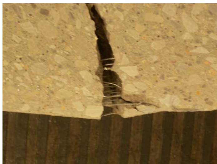
Figura 4.2 ARRIBA, PROBETA TRAS EL ENSAYO DE FLEXOTRACCIÓN. ABAJO DETALLE DE LA GRIETA Y FIBRAS INFERIORES.
