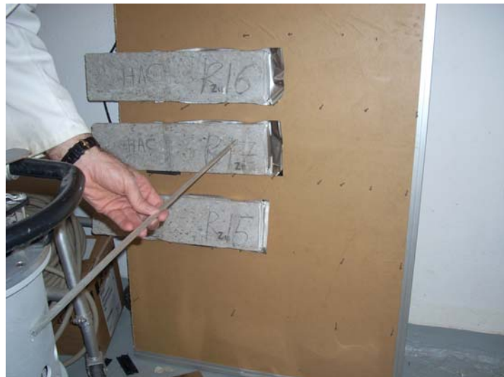
Figura 4.5 PROBETAS FRENTE AL TUBO DE RAYOS X. COMPROBANDO DISTANCIA DE 70 CM.
