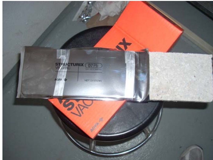
Figura 4.4 PLACA RADIOGRÁFICA FIJADA A PROBETA DE 10X40X2.5.
