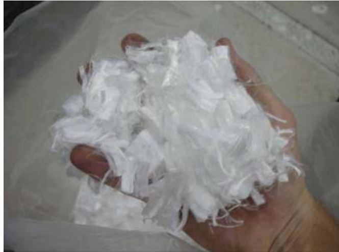
Figura 1.9 FIBRAS DE POLIPROPILENO PARA HORMIGÓN.
