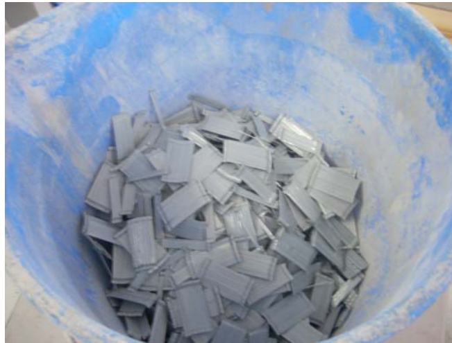
Figura 2.2 FIBRA DE ACERO CON BAÑO DE ZINC. 70/35
