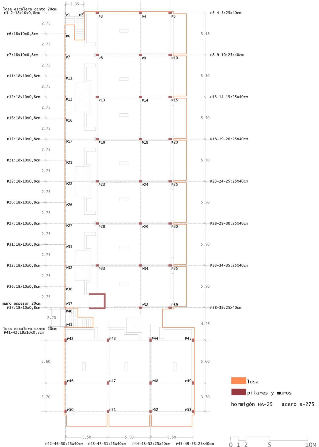
Figura 14: Planta estructural tipo de los forjados 2, 3, 4 y 5 (Modelo 1)
