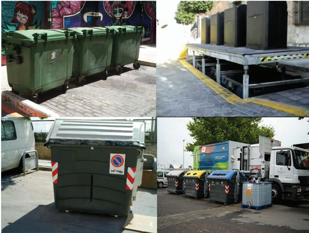
Imágenes n°s 69, 70, 71 y 72. Contenedores convencionales, soterrados, de carga lateral y camión de carga lateral.
