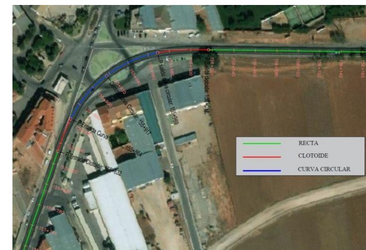
Figura 9: Estado de alineaciones en la N-310 en la glorieta de estudio
