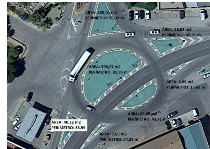
Figura 8: Áreas y perímetros de las isletas existentes
