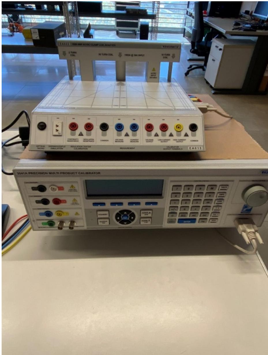
FIGURA 1. Equipo calibrador y estación base.
