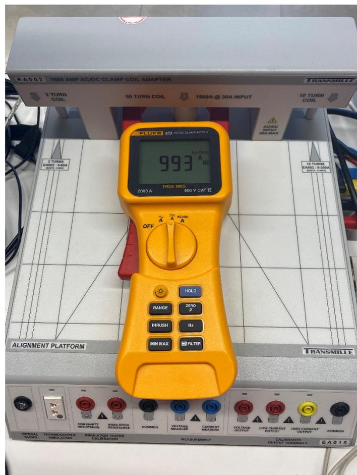
FIGURA 17. Colocación de la pinza amperimétrica en la bobina x50.
