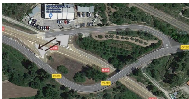
Fase 2. Intersección provisional en X.
