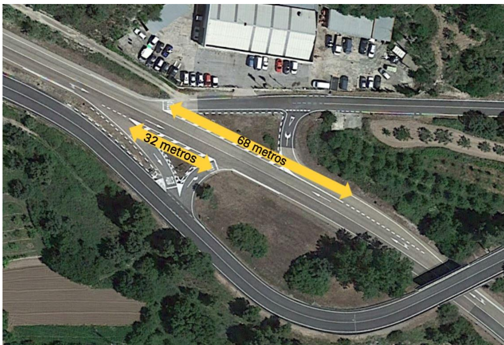
Imagen 3.4. Distancias entre salidas y entradas.
