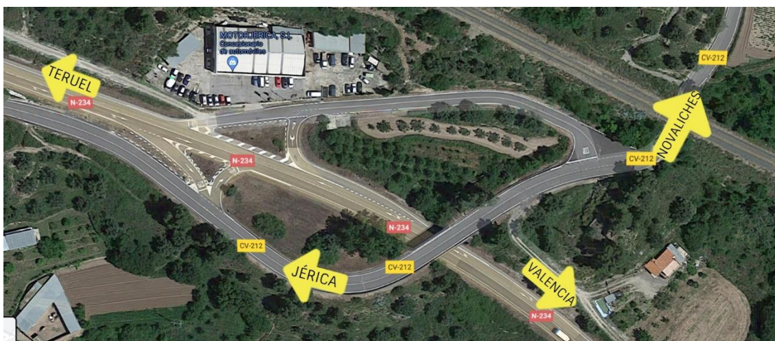
Imagen 3.1. Movimientos no permitidos con el enlace actual.
