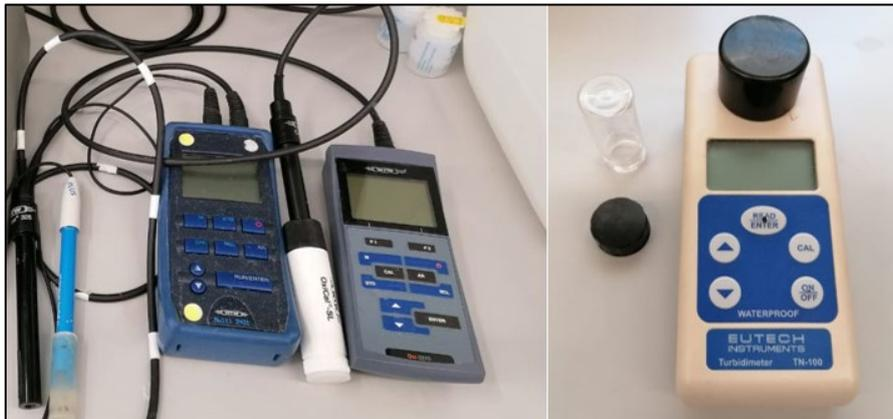
Figura 47. Phmetro (derecha), conductímetro (centro) y turbidímetro (izquierda)
