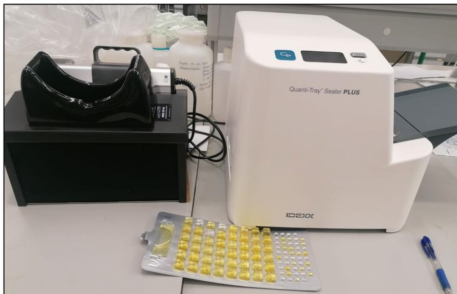
Figura 48. Equipo Quanti-tray sealer plus.
