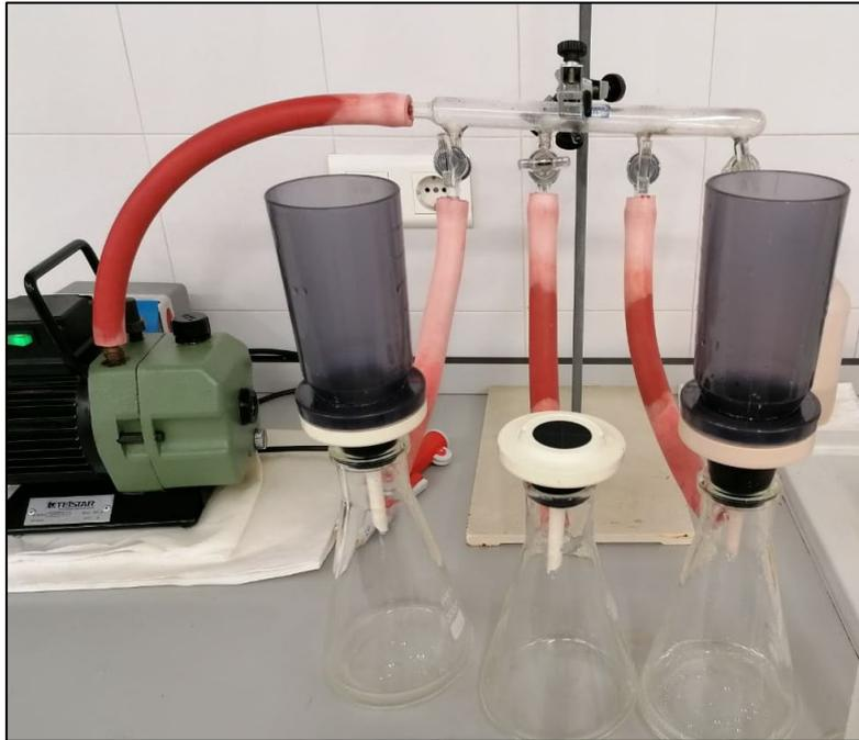
Figura 45. Filtrado al vacío para la determinación de sólidos suspendidos.
