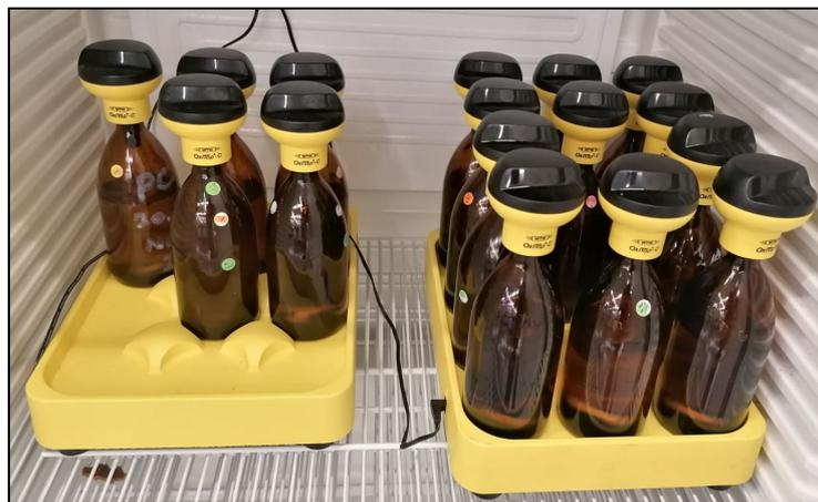
Figura 44. Muestras instaladas para el análisis de DBO.
