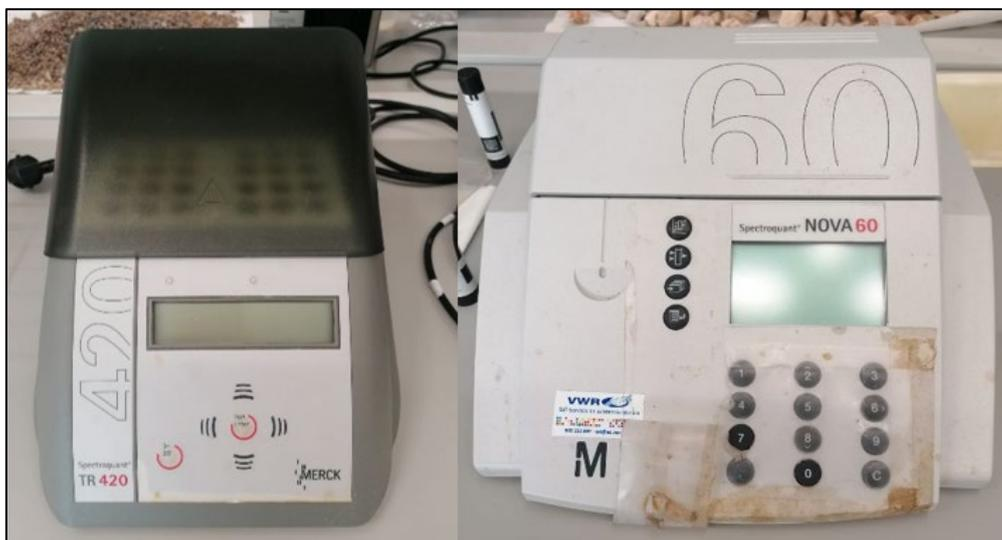
Figura 43. Termorreactor Spectroquant® (derecha) y Espectrofotómetro Spectroquant® (izquierda).
