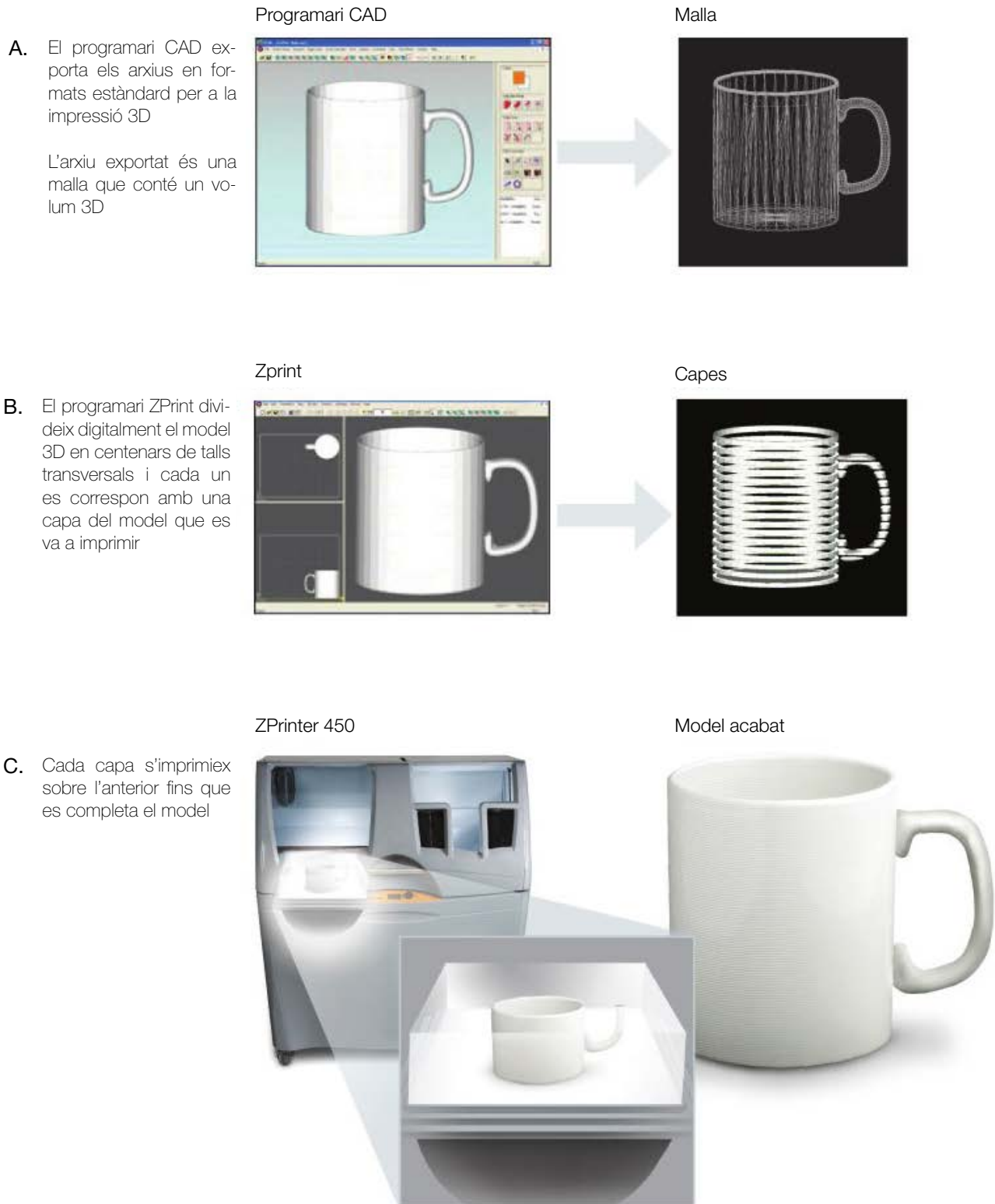
Fig.87: Infografia del Flux de treball del prototipat Font: Quadern Divulgatiu: sobre la Impressió 3D P. 5 . Z-Corporation
