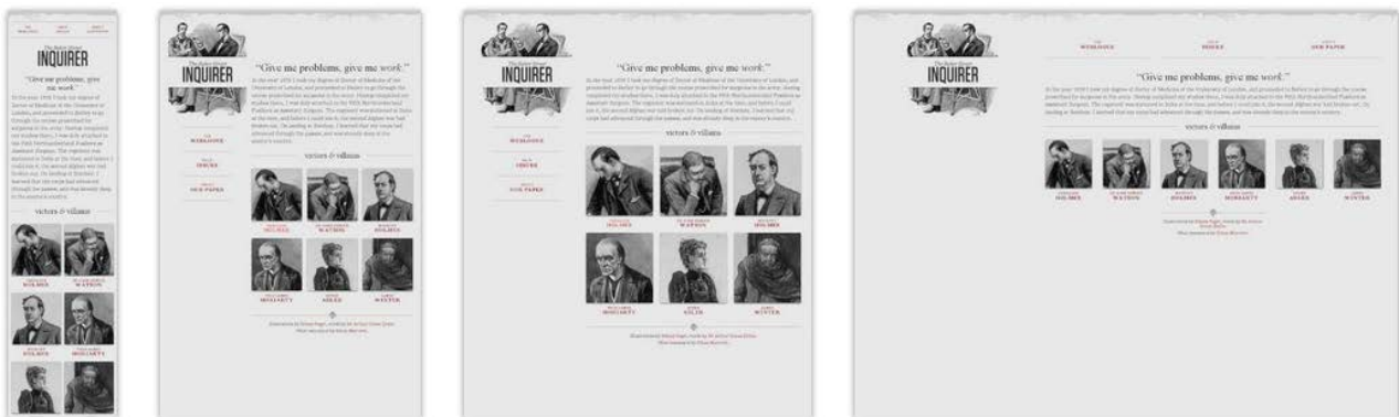
Figura 62: Web con diseño flexible, vista en diferentes anchos de pantalla. Ejemplo diseñado por Ethan Marcotte para explicar el Responsive Web Design en su artículo de A List Apart [25] Fuente: http://alistapart.com/article/responsive-web-design
