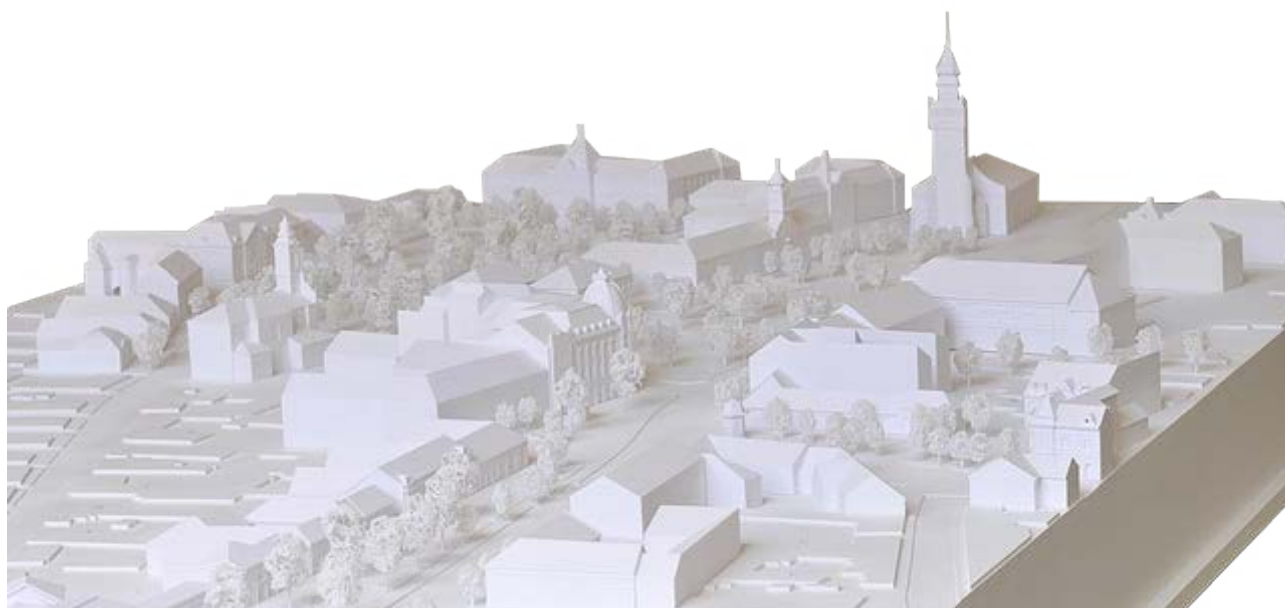
Figura 9. Maqueta imprimida con impresora 3D ZPrinter 350. Facultad de Arquitectura de Miklos.
