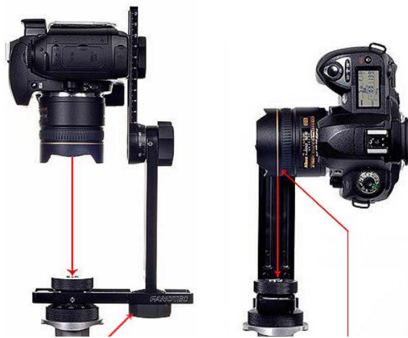
Figura 10. Calibración del cabezal panorámico Nodal Ninja
