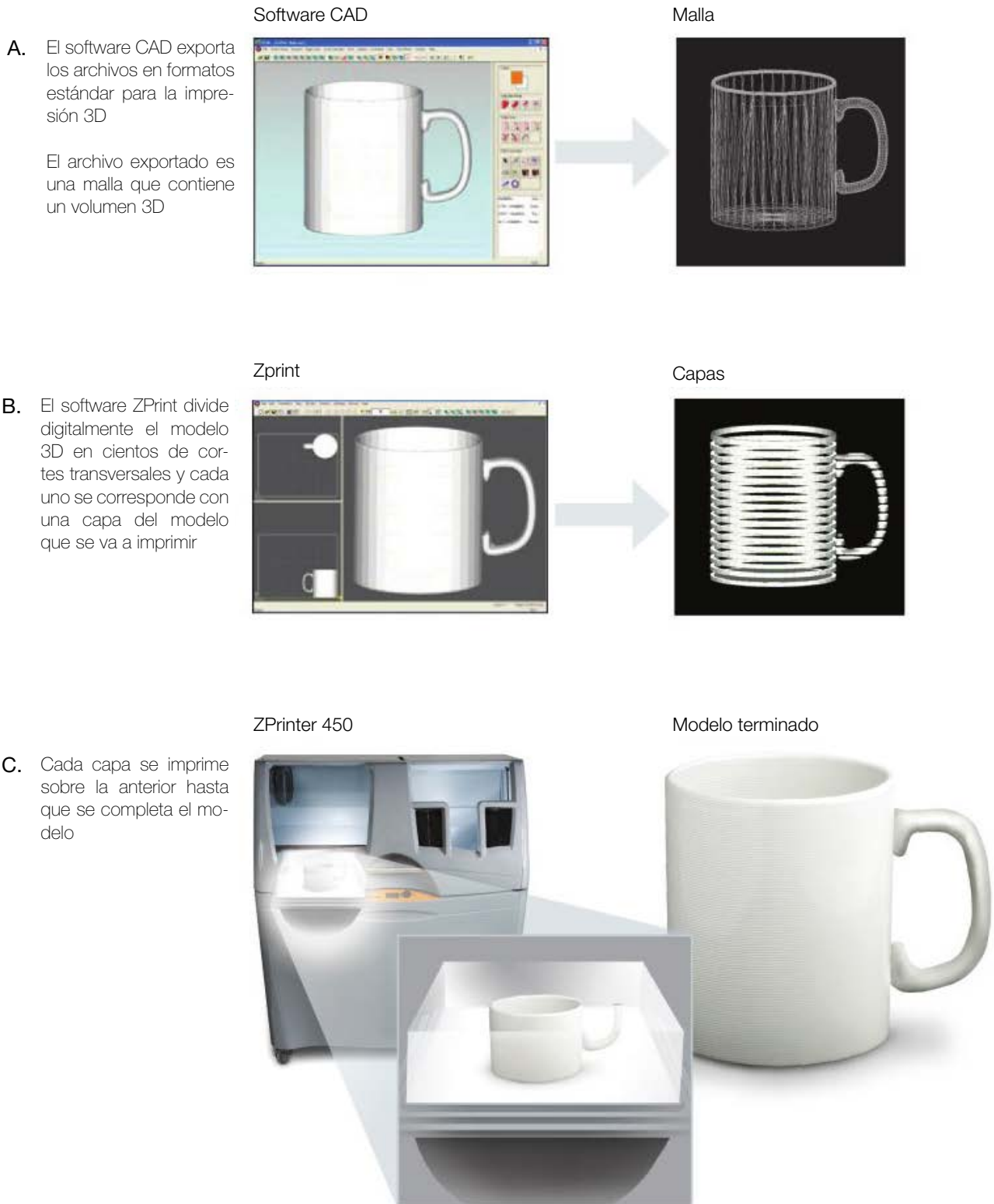
Fig.87: Infografía del Flujo de trabajo del prototipado Fuente: Cuaderno Divulgativo: sobre la Impresión 3D Pag. 5 . Z-Corporation
