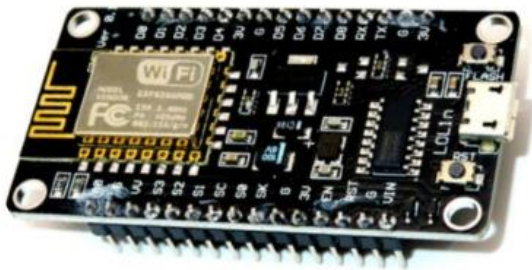
Figura 6. Módulo NodeMCU V3 CH340/ ESP8266
