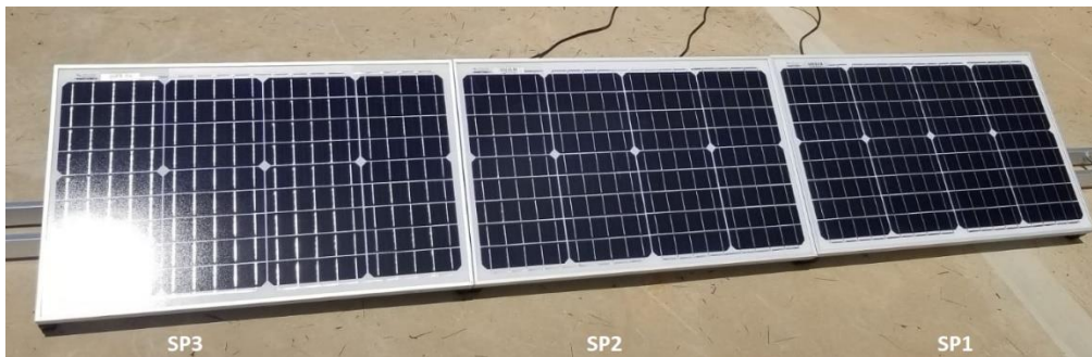
Figura 5. Paneles solares conectados en serie.
