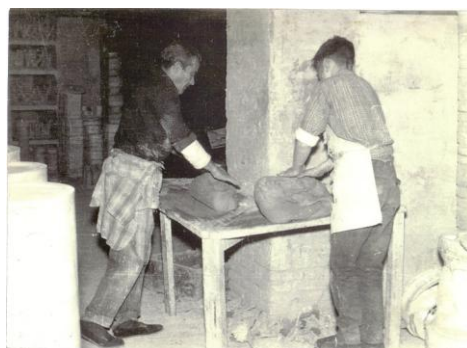
Figura 7. Operario amasando el barro. Fabrica de "La Pilarica" de Vicente Montaner. 1965. A. C. S
