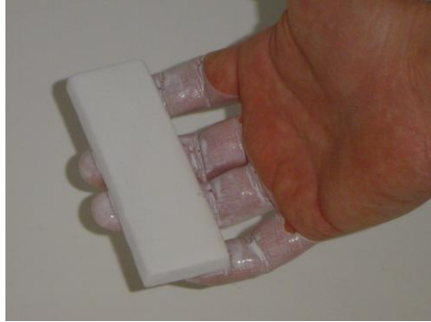
Figura 41. Barnizando las probetas
