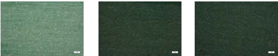
Figuras 157-159. Microfotografías de la probeta verde (V4), 80x y 25x , sometida a 30-60-90 ciclos/min de abrasión.
