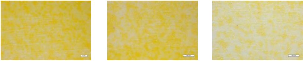
Figuras.152-154. Microfotografías de la probeta amarilla (A4), 80x y 25x, sometida a 30-60-90 ciclos/min de abrasión.
