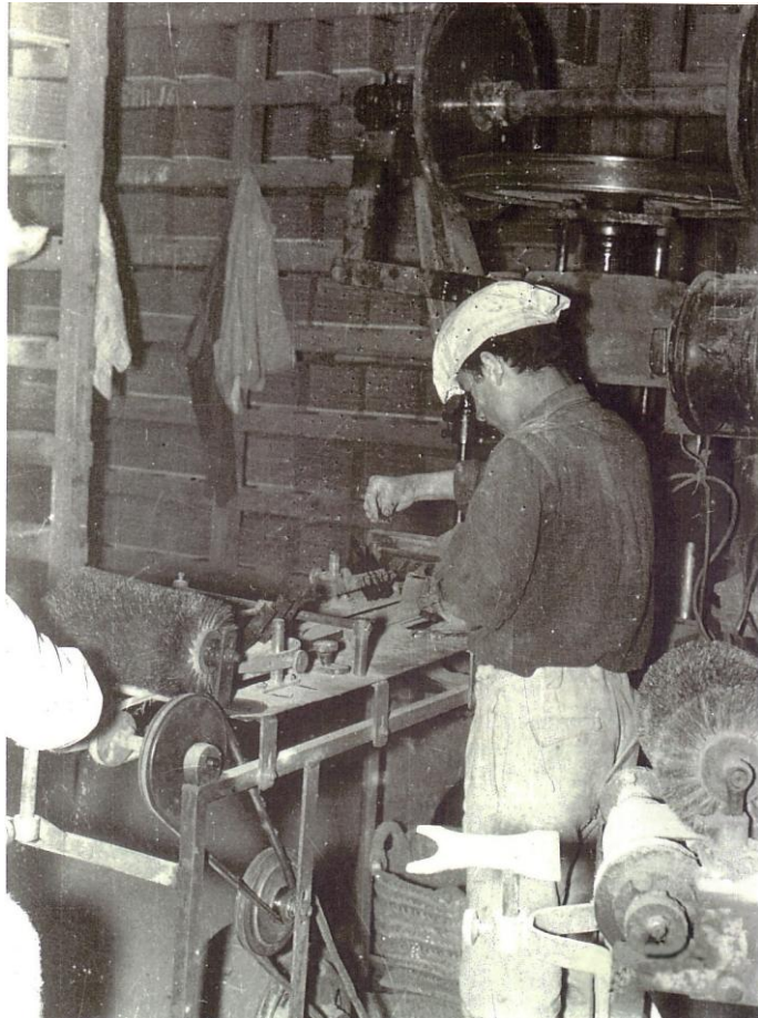
Figura 12. Operario con la máquina de limpiar azulejos después de ser barnizados. Al fondo una prensa antigua de fabricación de azulejos. 1960. Archivo Carlos Sanchis
