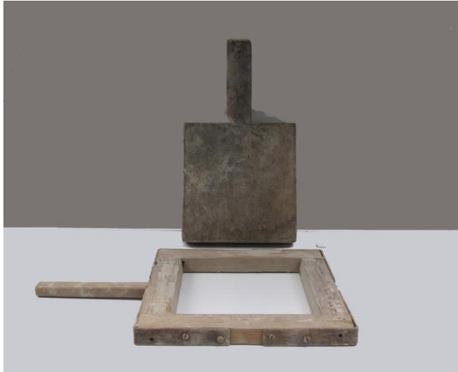
Figura 8. Bastidor de madera para realizar azulejos. Museo de Cerámica de Manises
