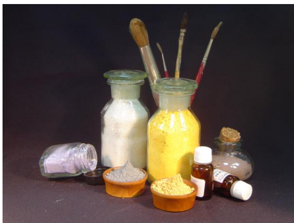
Figura 20. Distintos óxidos empleados en la decoración de los azulejos, así como los lustres de 10 quilates
