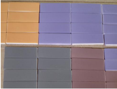
Figura 42. Probetas decoradas a pistola
