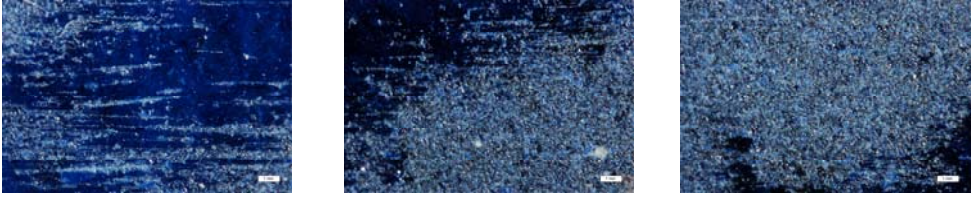
Figuras 192-194. Microfotografías de la probeta azul reflejo (AzR4), 80x y 50x, sometida a 30-60-90 ciclos/min de abrasión.
