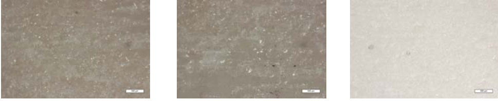
Figuras 182-184. Microfotografías de la probeta blanco reflejo (BR4), 80x y 40x, sometida a 30-60-90 ciclos/min de abrasión.
