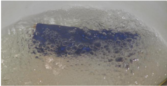
Figura 50. Probetas en agua caliente a 130°
