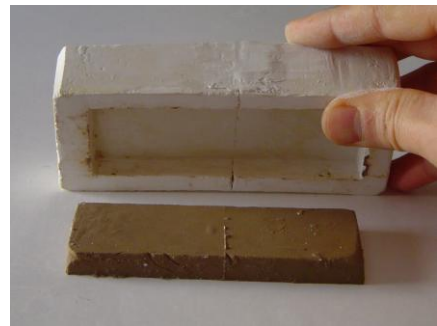
Figura 38. Llenado de los moldes por apretón
