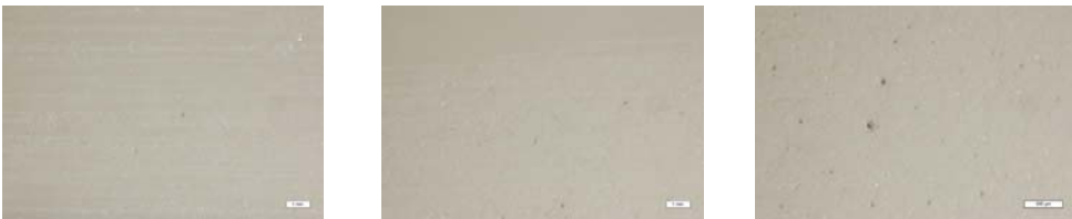
Figuras. 147-149. Microfotografías de la probeta blanca (B4), 80x y 25x, sometida a 30-60-90 ciclos/min de abrasión.
