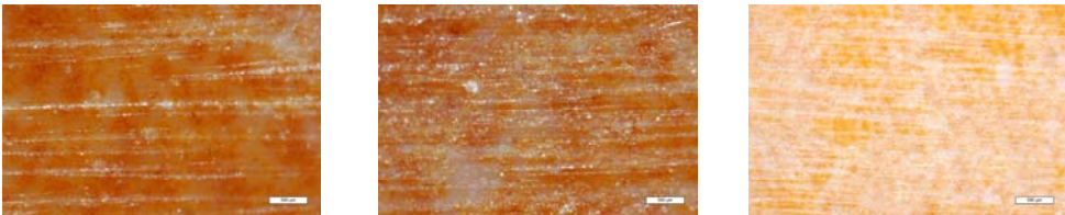
Figuras 167-169. Microfotografías de la probeta naranja (N4), 80x y 25x, sometida a 30-60-90 ciclos/min de abrasión.
