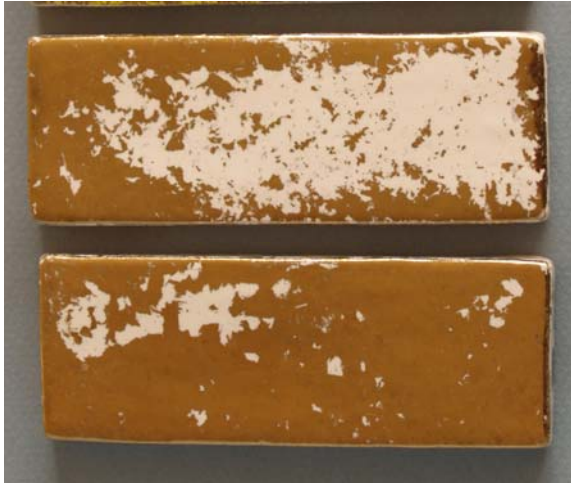
Figura 210. Probetas de Plata y oro cuyos valores han sido excluidos, tras su ensayo en la cámara de envejecimiento acelerado por \text{SO}_2 .
