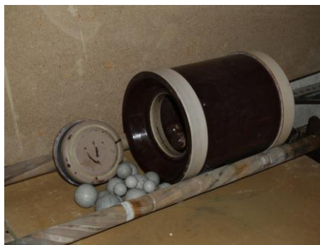
Figura 18. Bombo de laboratorio. Taller A. Mora
