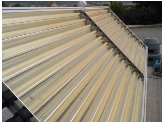
Figura 4.3.5: Planta piloto de fotocátalisis solar de 50 L
