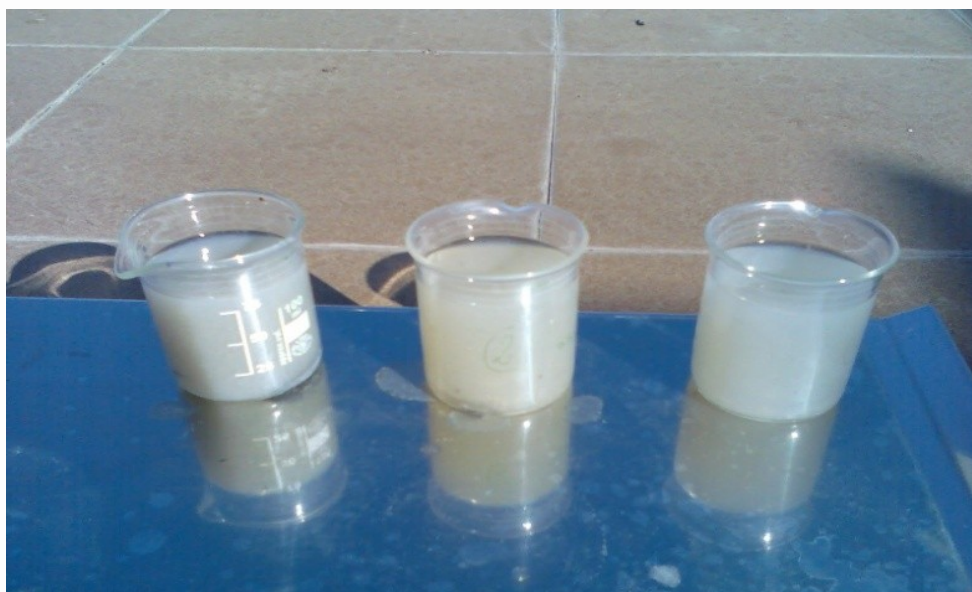
Figura 4.6.3.1: Tratamiento con \text{TiO}_2 con varias concentraciones de fotocatalizador
