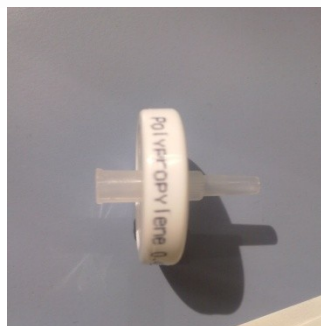
Figura 4.1.2: Características de los filtros de polipropileno
