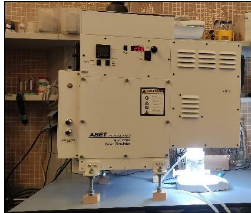
Figura 3.3.1-1. Simulador solar utilizado en los experimentos a escala de laboratorio. ABET Sun 2000.
