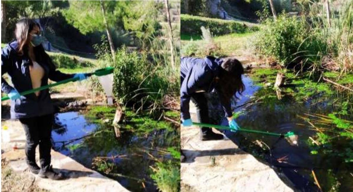
**Figura 36.** Muestreo de macroinvertebrados con red. Fuente: Elaboración propia.
