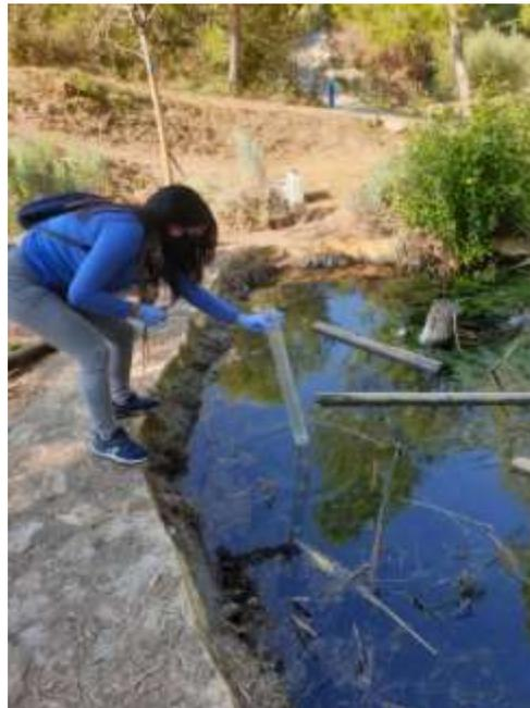
**Figura 35.** Muestreo de macroinvertebrados con tubo. Fuente: Elaboración propia.
