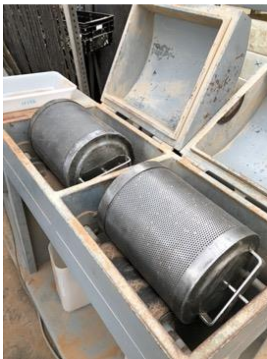
figura 5. Tamizador mecánico con filtros de 2 mm de diámetro.
