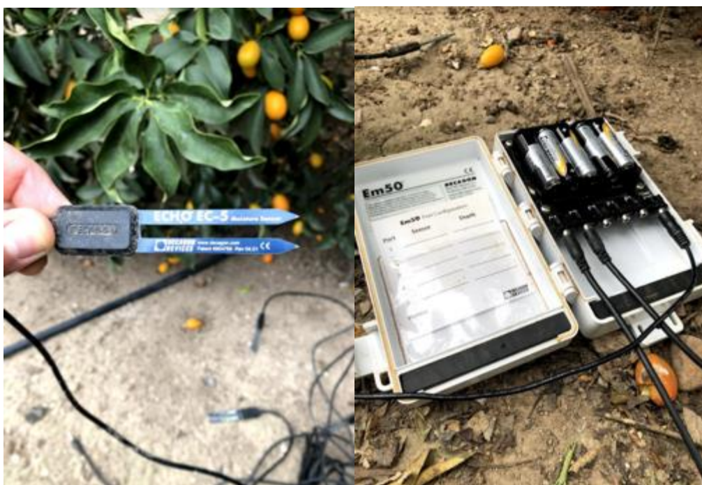
figura 4. A la izquierda los sensores de capacitancia. A la derecha el datalogger EM50.
