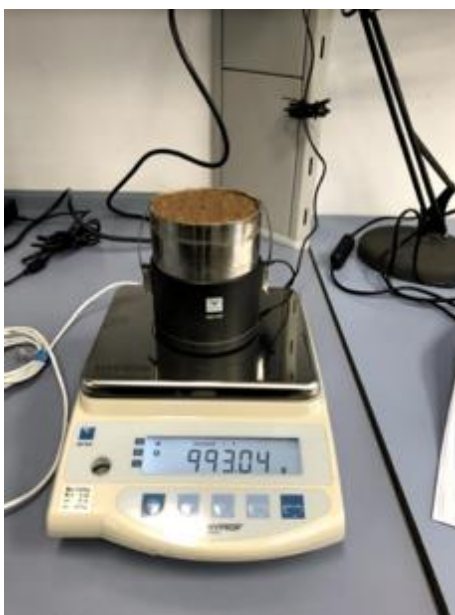
figura 8. Montaje del sistema HYPROP.
