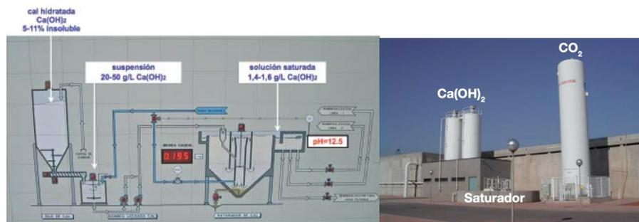
Figura 54. A la izquierda, el esquema de una instalación de preparación de lechada de cal. A la derecha, planta de tratamiento con Ca(OH)<sub>2</sub> y CO<sub>2</sub>.
