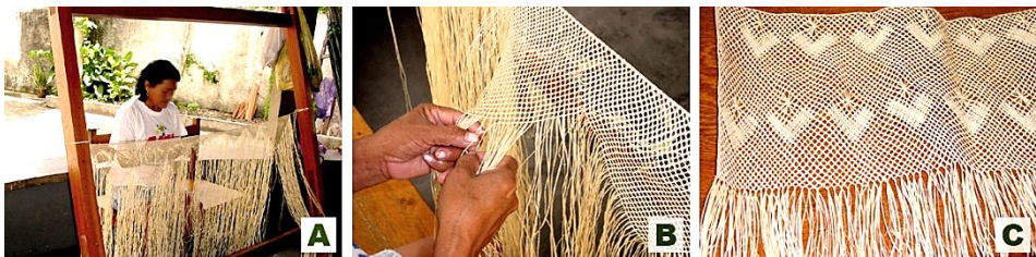
A3_Figura 6. A- Telar hecho con fibras in natura de tucum; B- Entrelazado de las fibras para la transformación del tejido; C- Tejido plano confeccionado con las fibras de tucum. Fuente: de los autores.
