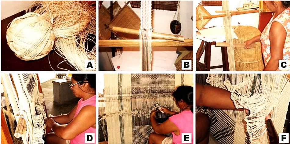
A3_Figura 5. A- Hilos de tucum que van a ser utilizados para el telar; B- Hilos introducidos en el telar manual para la confección del tejido; C - Ajustes de los hilos para proceder con el tejido; D, E y F - Producción del tejido con textura más gruesa en un telar vertical de mayor tamaño. Fuente: de los autores.
