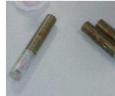
Figura 46. Electrodo de trabajo. Acero 500sd.
