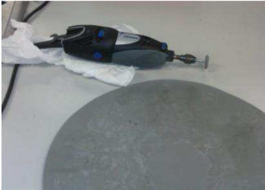
Figura 45. Pulidora eléctrica y discos de lija.
