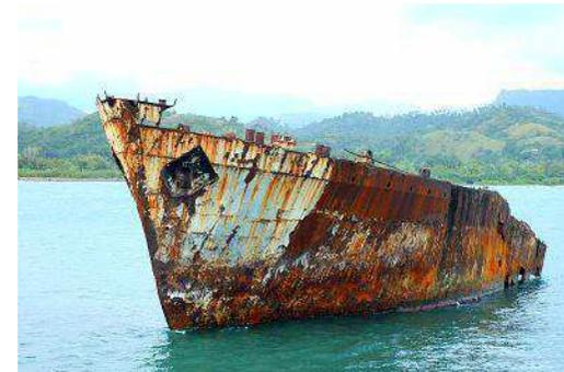
Figura 9. Fotografía de una embarcación próxima al mar expuesta a corrosión en ambiente marino.
