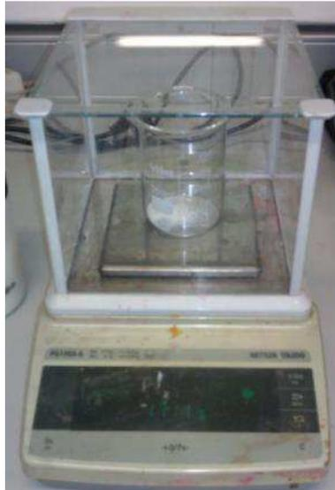
Figura 43. Soluta dentro del vaso de precipitados en la balanza
