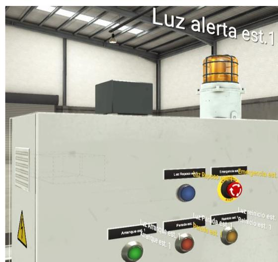
Figura 35: Modelado en Factory I/O del cuadro de mandos de la estación 1
