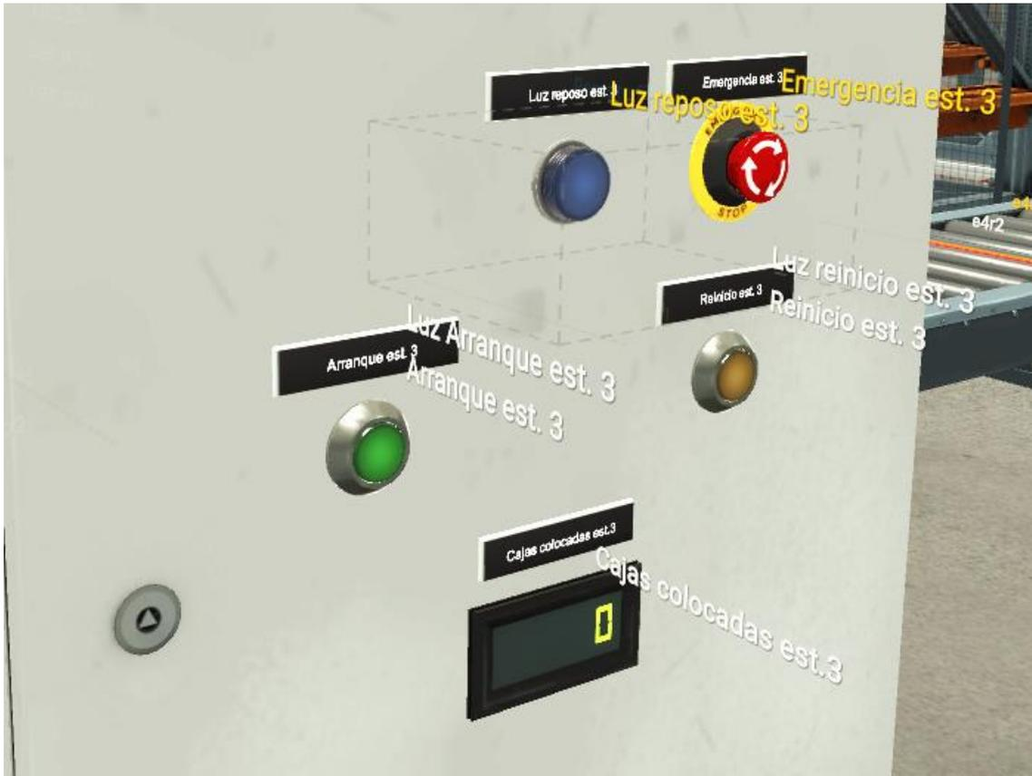
Figura 40: Modelado en Factory I/O del cuadro de mandos de la estación 3
