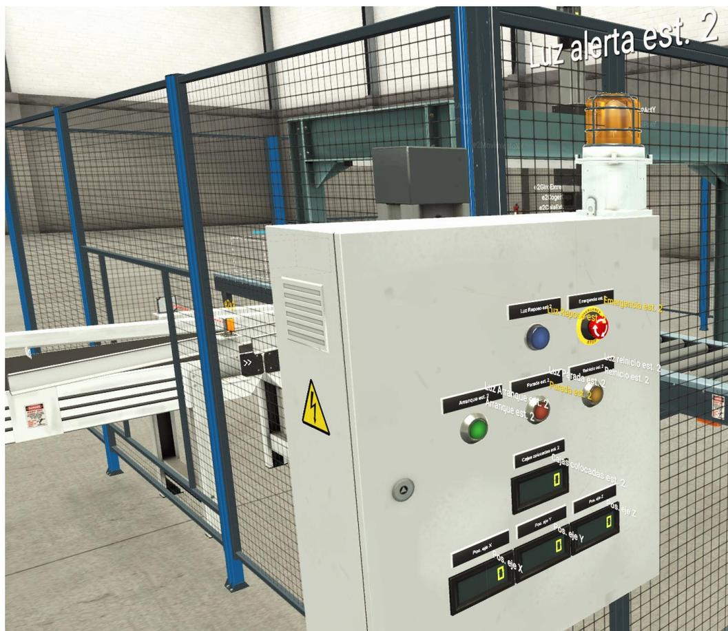
Figura 37: Modelado en Factory I/O del cuadro de mandos de la estación 2
