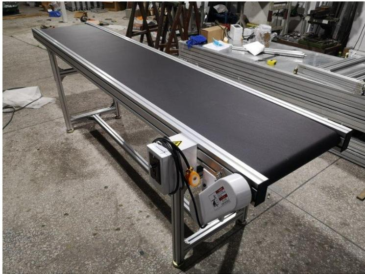
Figura 15: Ejemplo de cinta transportadora con banda de PVC de la marca JiaBao [14]
