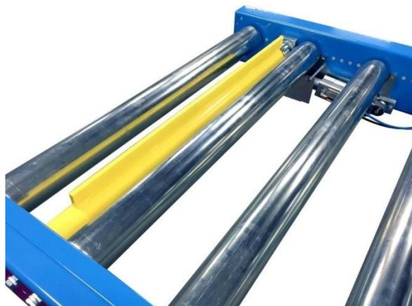
Figura 16: Ejemplo de parador de palés en cintas de rodillos [15]
