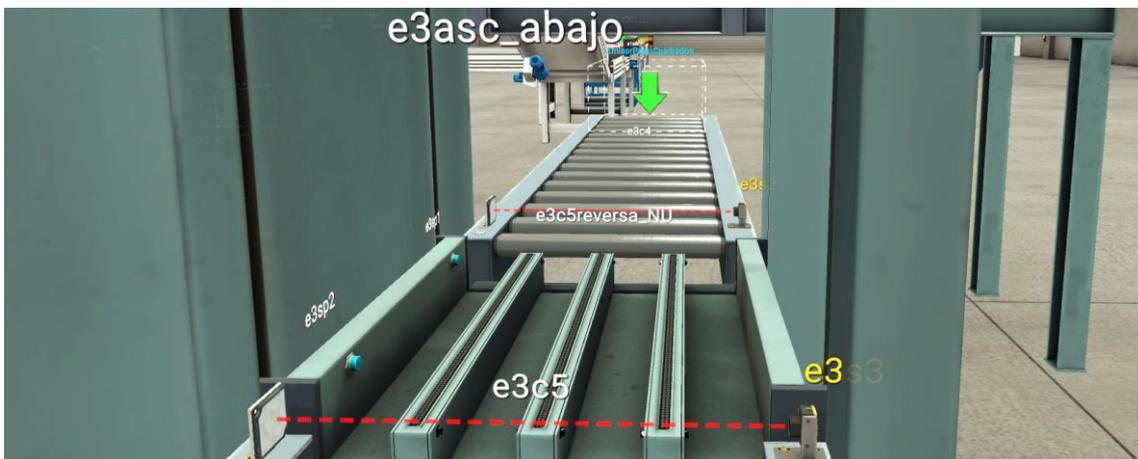
Figura 39: Modelado en Factory I/O de la parte inferior de la estación 3
