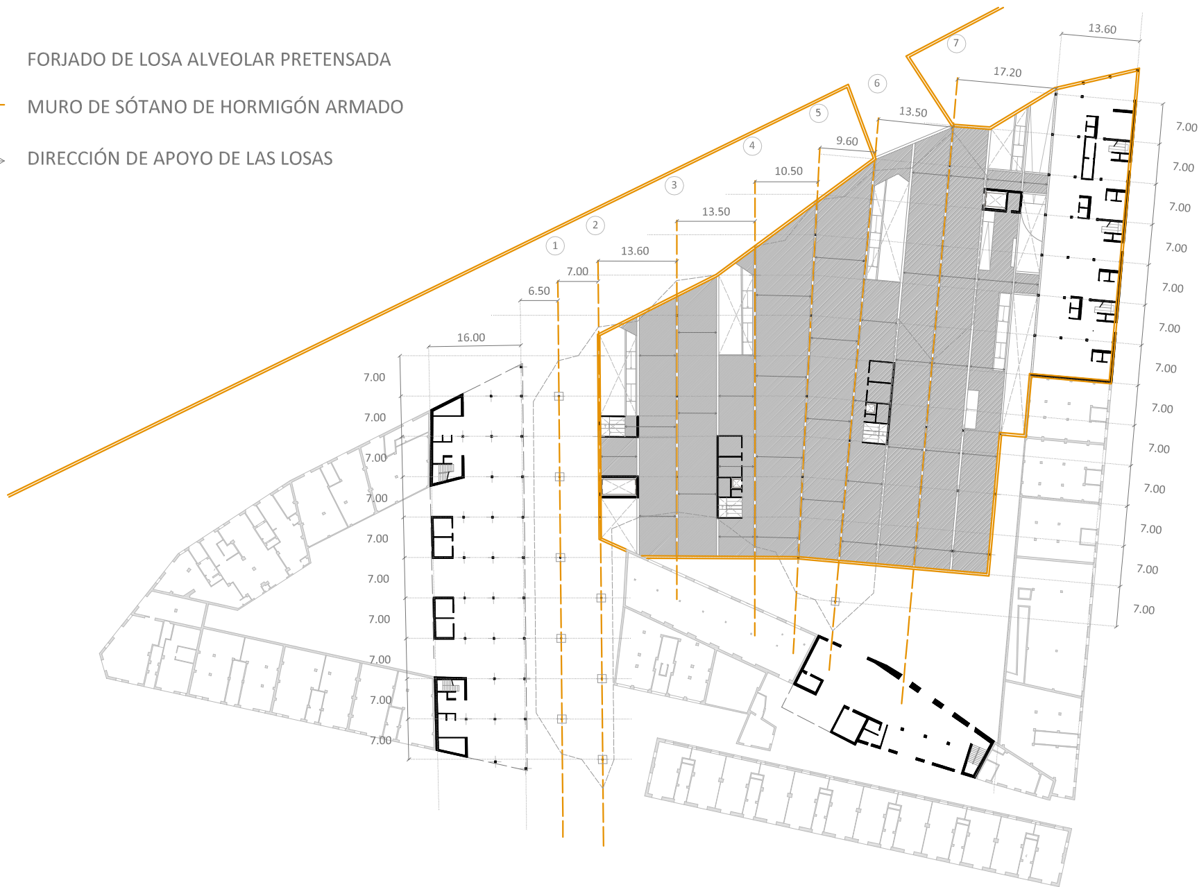
PLANO DE ESTRUCTURA PLANTA BAJA
