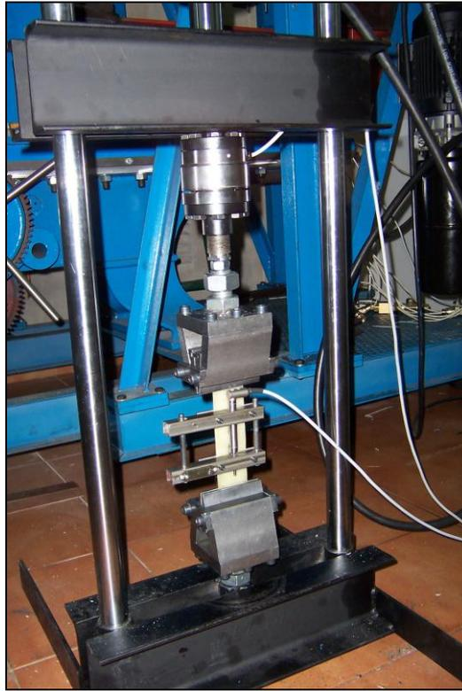
*Figura 2. Máquina de ensayos para materiales compuestos*
