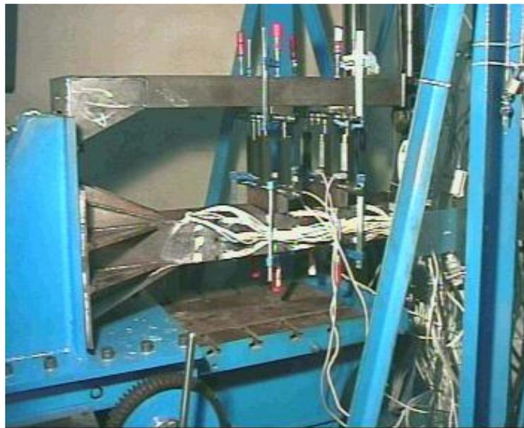
*Figura 1. Máquina de ensayos a flexotorsión*
