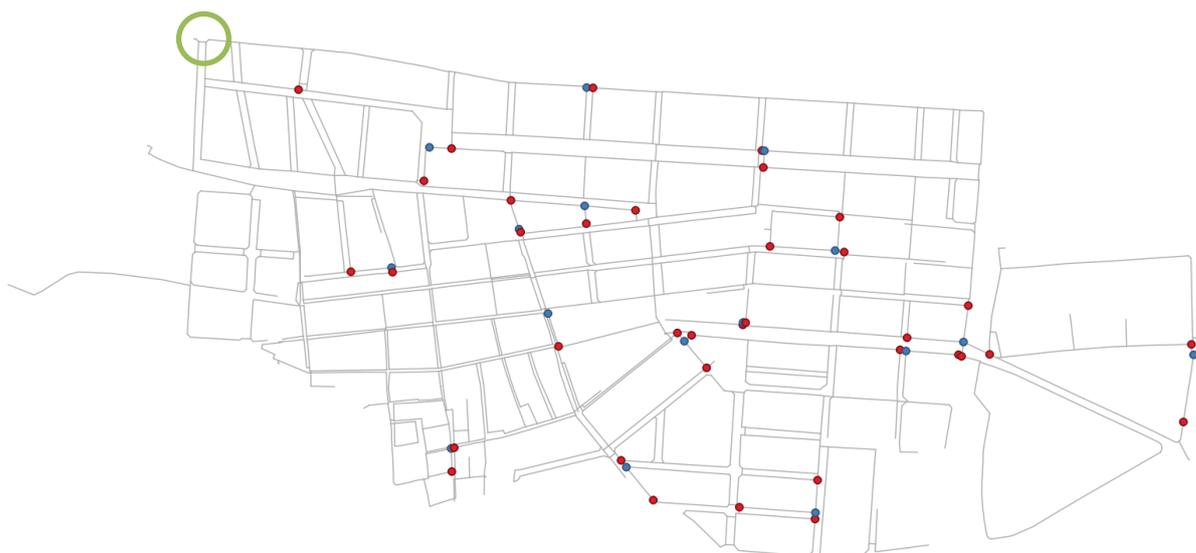
Figura 5.30 Ubicación real de la fuga (verde) y resultado del modelo de localización (azul y rojo)
