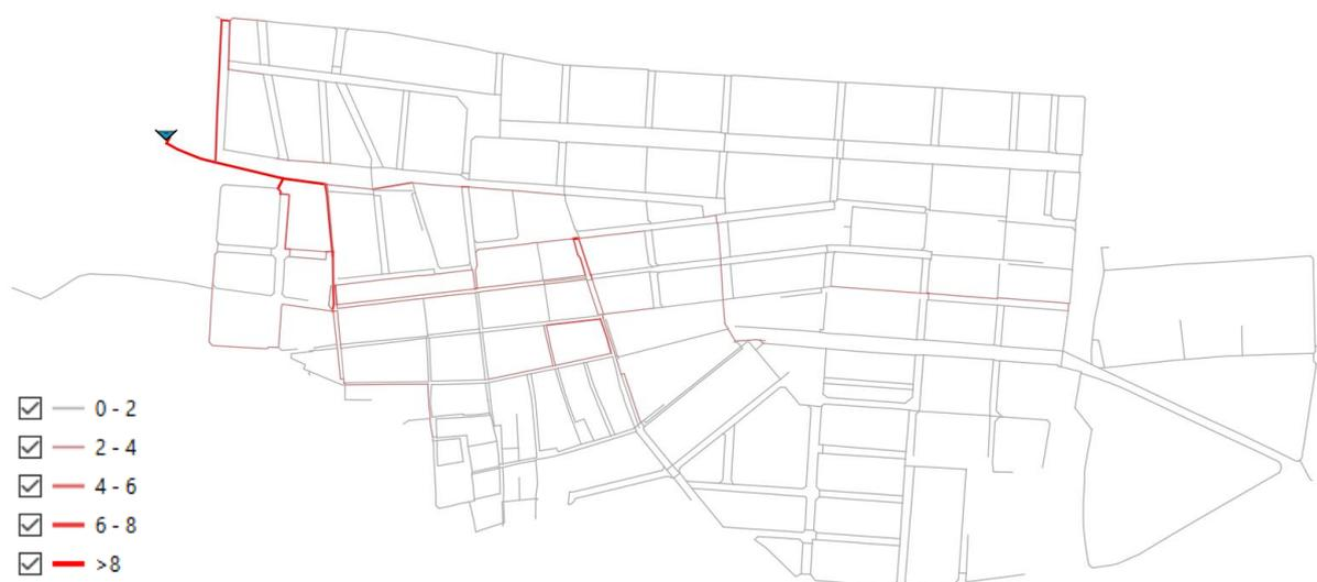
Figura 5.28 Variaciones de caudal (l/min), en valores absolutos, en las líneas ante una fuga de 30 l/min
