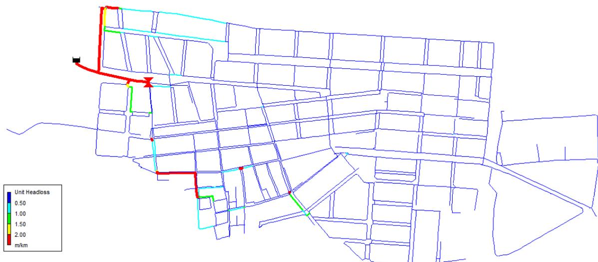
Figura 5.19 Pérdidas de carga en las tuberías de distribución
