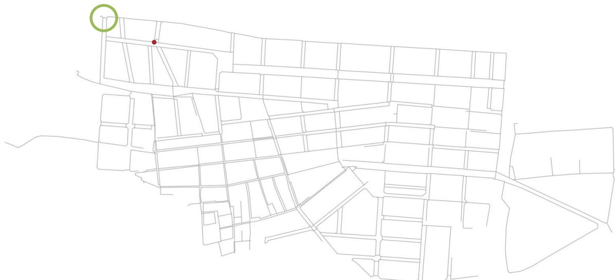
Figura 5.32 Ubicación real de la fuga (verde), nudo J67, y sensores con caudal fugado asignado (rojo)
