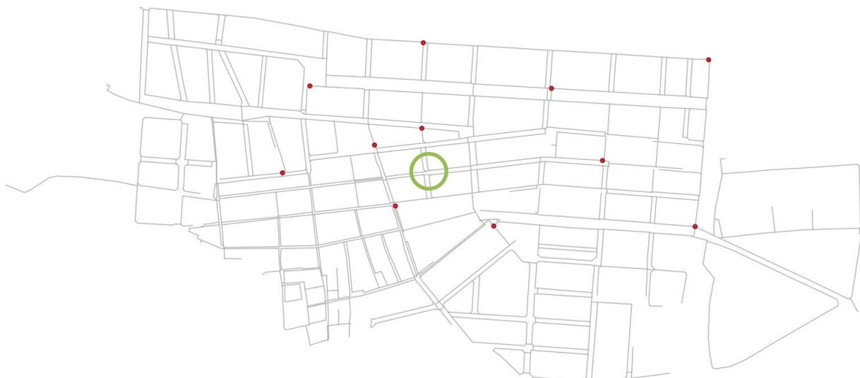
Figura 5.34 Ubicación real de la fuga (verde), nudo J465, y sensores con caudal fugado asignado (rojo)
