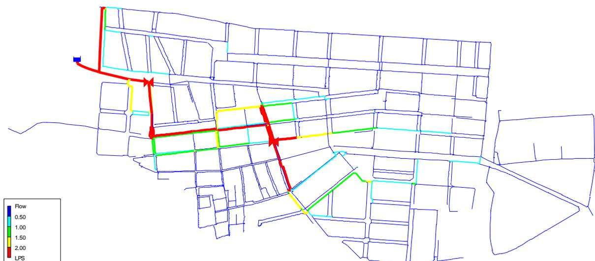
Figura 5.23 Caudales en las tuberías de distribución bajo la sectorización propuesta
