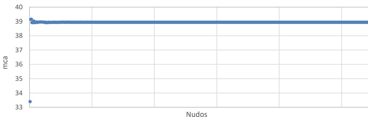
Figura 5.27 Evolución de la presión en el nudo J18 ante una fuga de 30 l/min en cada uno de los nudos de la red
