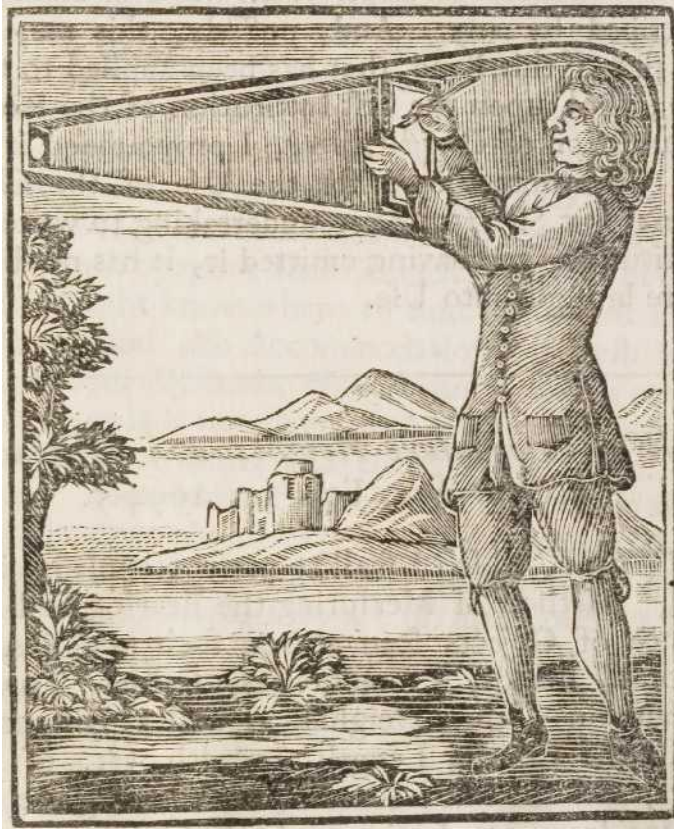
Figura : Robert Hooke, Camera Obscura portátil, 1694
