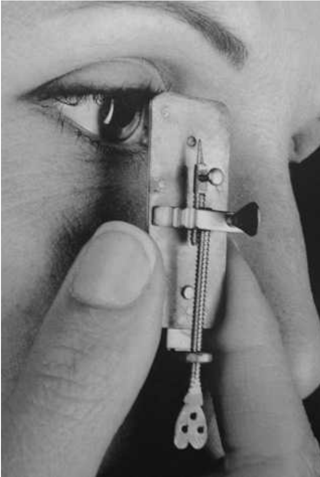
Figura : Microscópio de Leeuwenhoek, 2ª metade do séc. XVII
