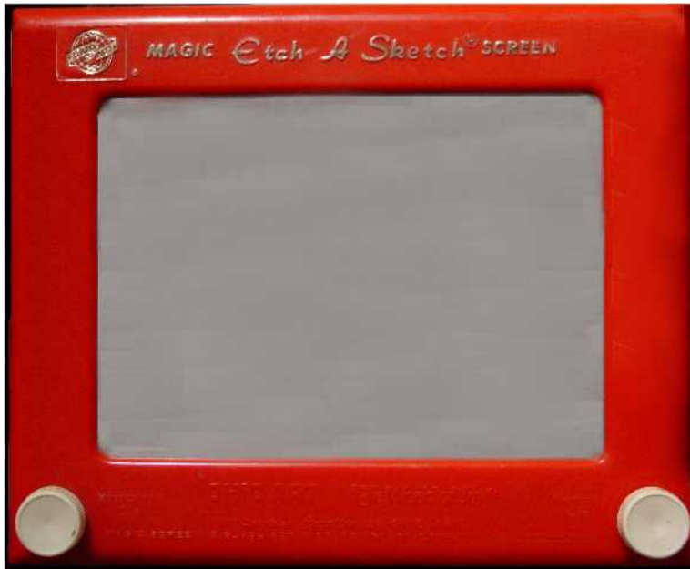
Figura : Etch-A-Sketch, superfície transparente coberta de pó de alumínio, com dois botões para controlar o ponteiro
