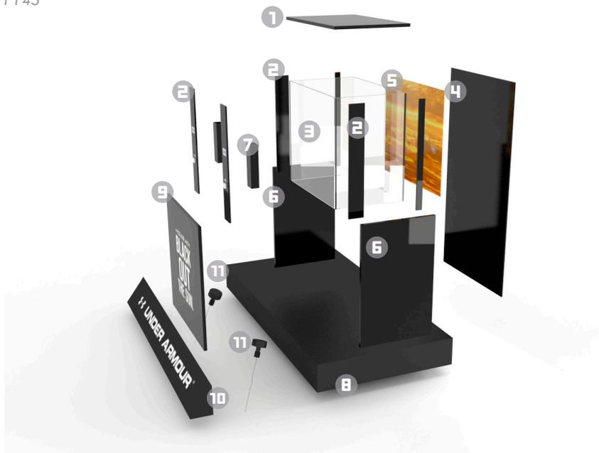
F145. Despiece del display diseñado para la línea Under Armour ColdBlack.
