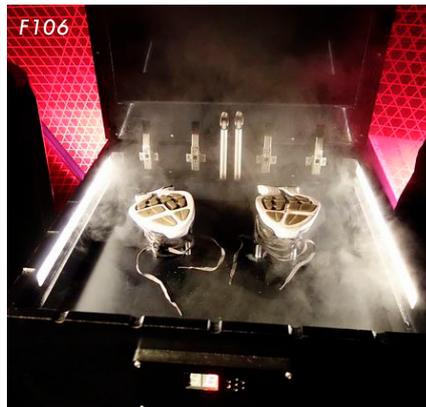
F105. Proceso de calentamiento mediante vapor de las Nike Flyknit Lunar.
