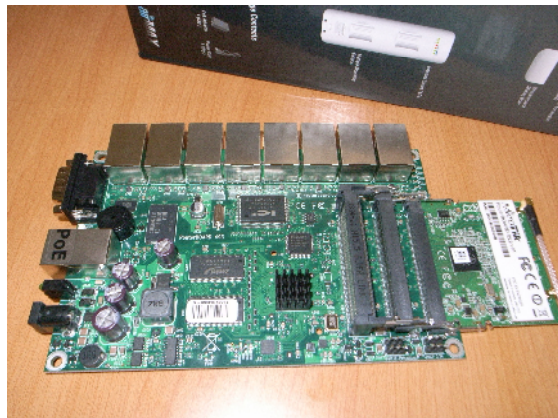
Figura 3.7. Fotografía Routerboard con Mikrotik
