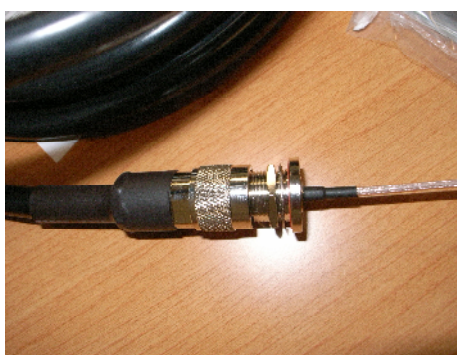
Figura 3.10. Fotografía conexión pigtail-Nmacho
