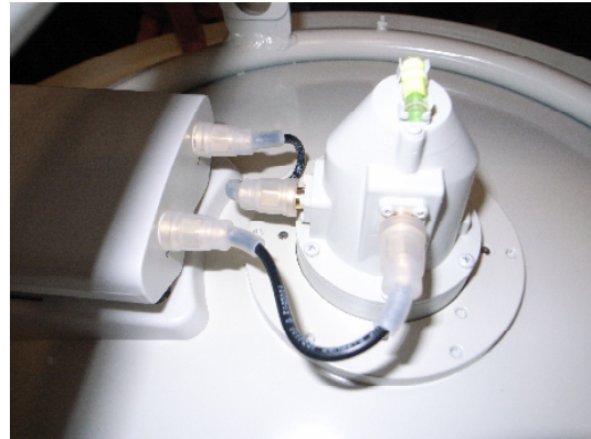
Figura 3.19. Fotografías ensablado Rocket M5 en Rocket Dish Base
