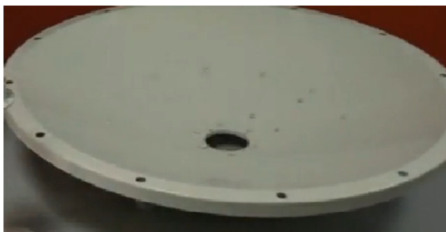
Figura 3.18. Fotografías ensamblado antena parabólica
