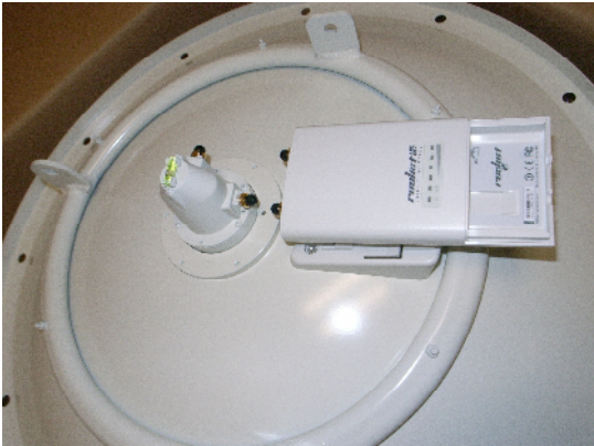
Figura 3.19. Fotografías ensablado Rocket M5 en Rocket Dish Base
