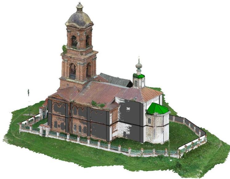
Ilustración 26 – Modelado de la volumetría mediante fotogrametría. Fuente: elaboración propia
