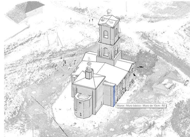
**Ilustración 28** – Modelado de la volumetría mediante nube de puntos y escáner laser. Fuente: elaboración propia
