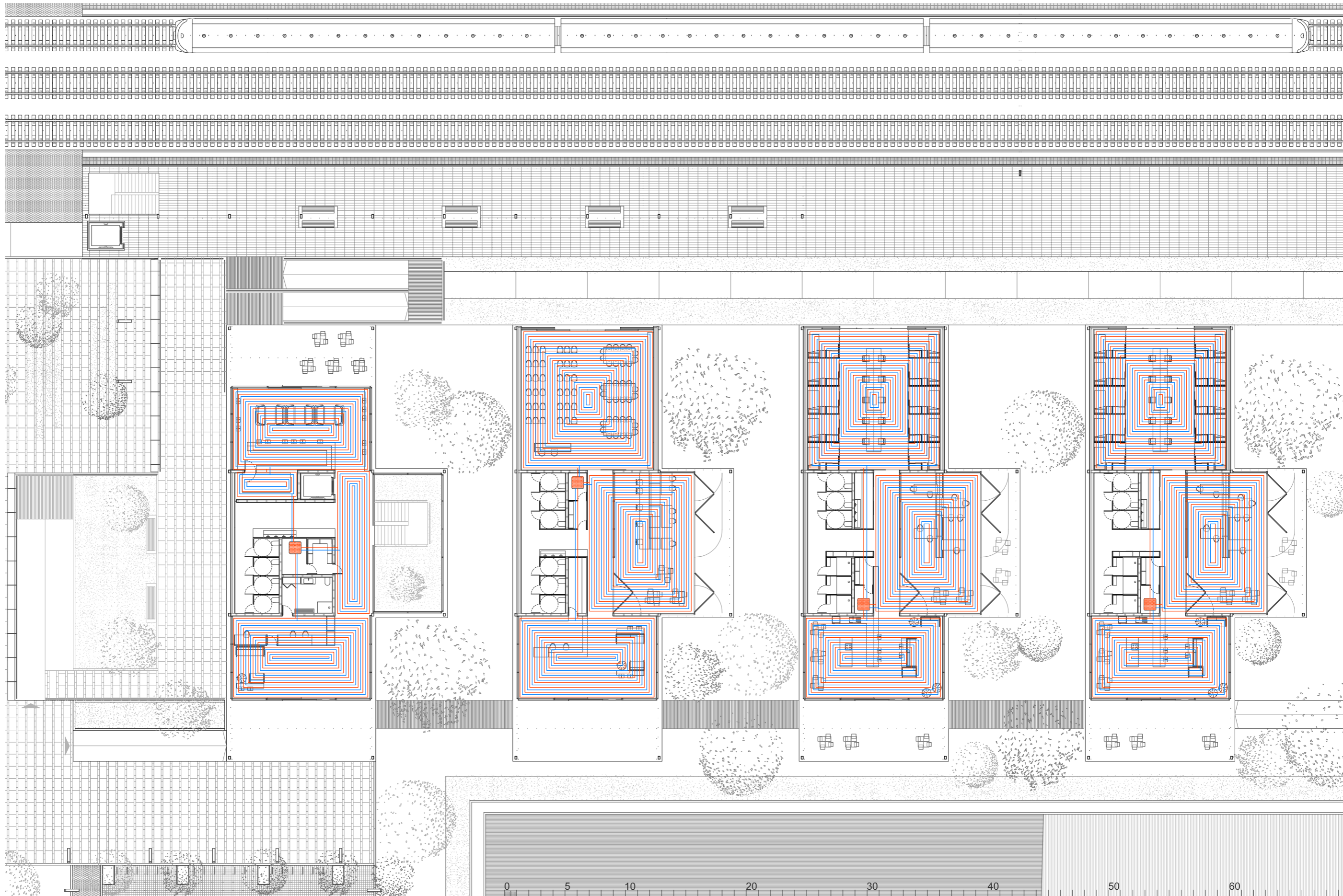
CALEFACCIÓN POR SUELO RADIANTE. Planta principal.
