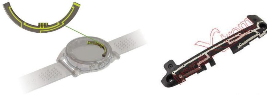
Figura 12. Ejemplos de PIFA en IoT
