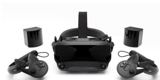
Fig. 5: HMD Valve Index con sus componentes.
