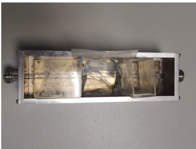
Figura 44: Definición de los planos de la bolsita sobre la guía
