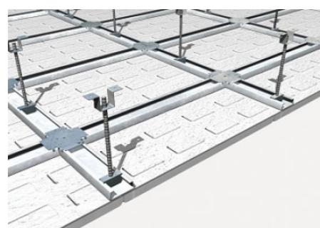
Falso Techo de escayola
