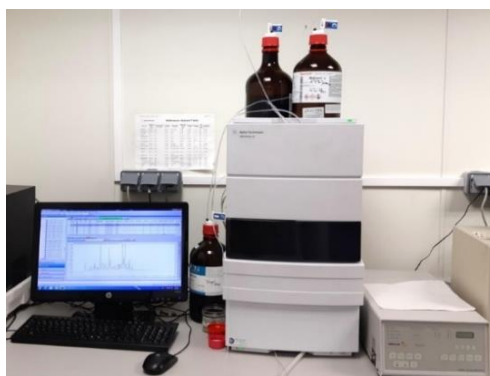
Figura 20. Instrumento HPLC, asociado al monitor y un detector de índice de refracción (IR). Fuente: elaboración propia.
