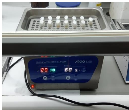
Fuente 24. Muestras de pimiento en baño de ultrasonidos bajo campana de extracción.
