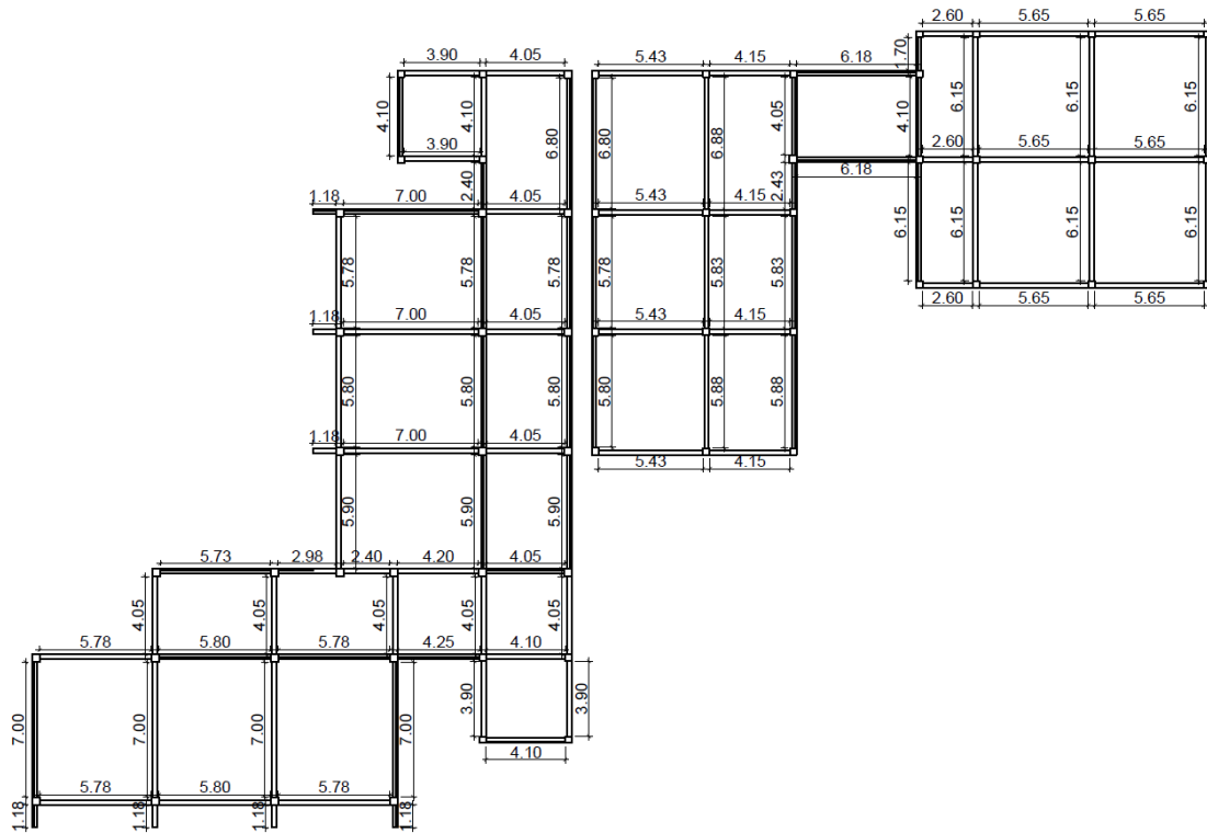
Imagen 47: Vigas planta tipo
