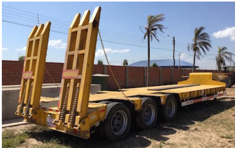
Imagen 78: Lowboy para transporte de columnas
