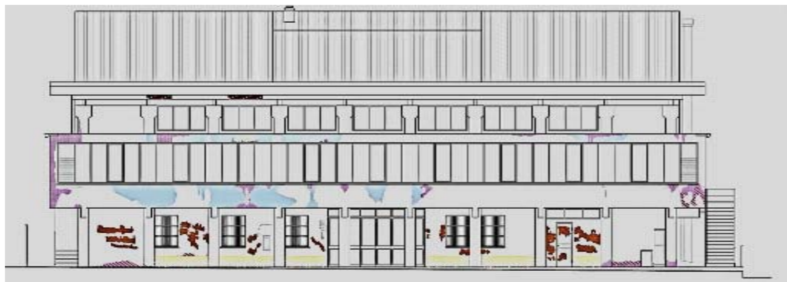
Fachada principal. Rotura del canalón, humedad, patina biológica, fisuras, deterioro y desprendimiento del enlucido, grafitis. Facciata principale. Rottura di grondaia, umidità, patina biologica, fessurazione, degrado e distacco dell'intonaco, murali in vernice indelebile.
