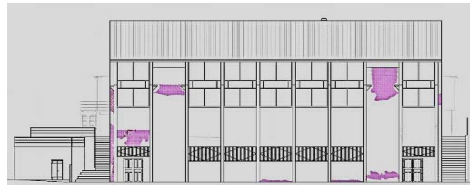
Fachada posterior. Humedad por capilaridad, fisuras, deterioro y desprendimiento del enlucido. Facciata posteriore. Umidità da risalita capillare, fessurazione, degrado e distacco dell'intonaco.
