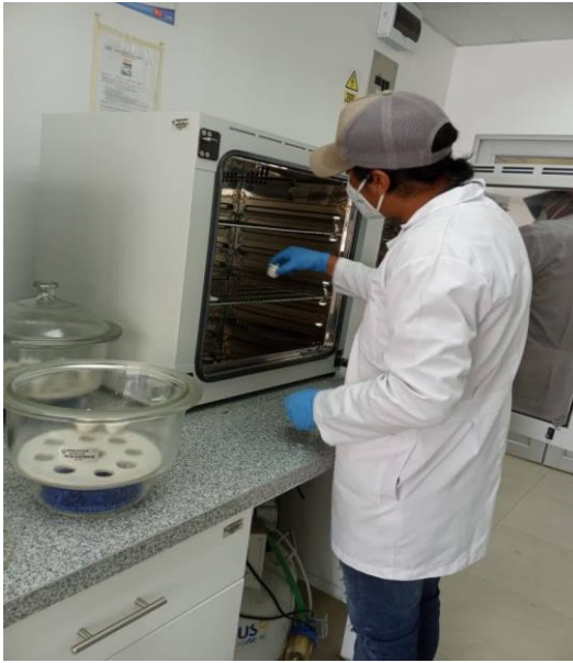
Figura 7. Secado en estufa de muestras para análisis de contenido de humedad.
