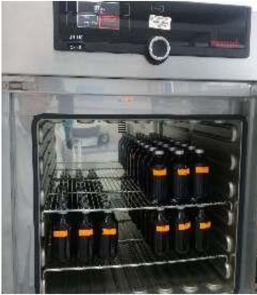
Figura 15. Digestores en estufa a una temperatura constante de 35°C.
