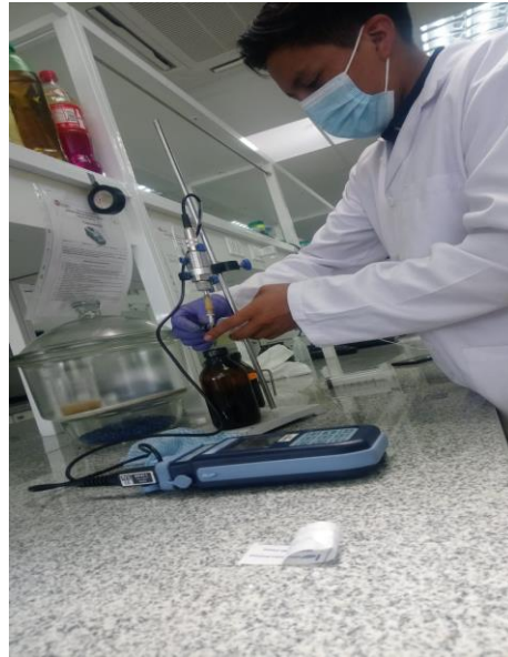
Figura 16. Medición de la presión en los digestores.
