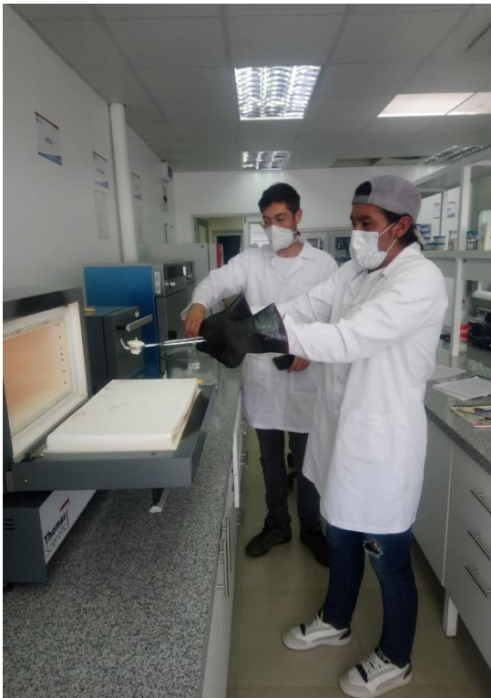
Figura 7. Secado en estufa de muestras para análisis de contenido de humedad.
