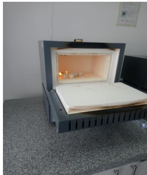
Figura 8. Muestras en mufla para determinación de contenido de cenizas.
