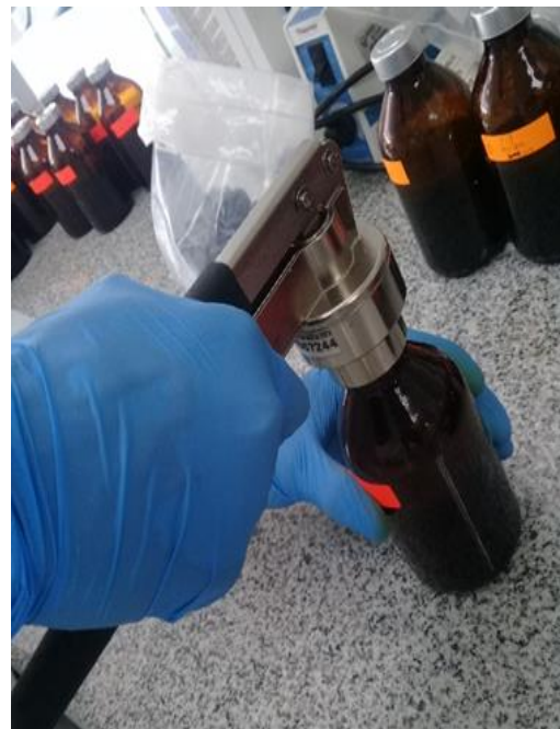
Figura 12. Preparación de la carga para introducir en los digestores.
