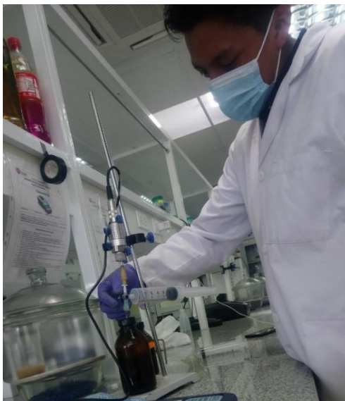
Figura 17. Medición del volumen de biogás obtenido en los digestores.
