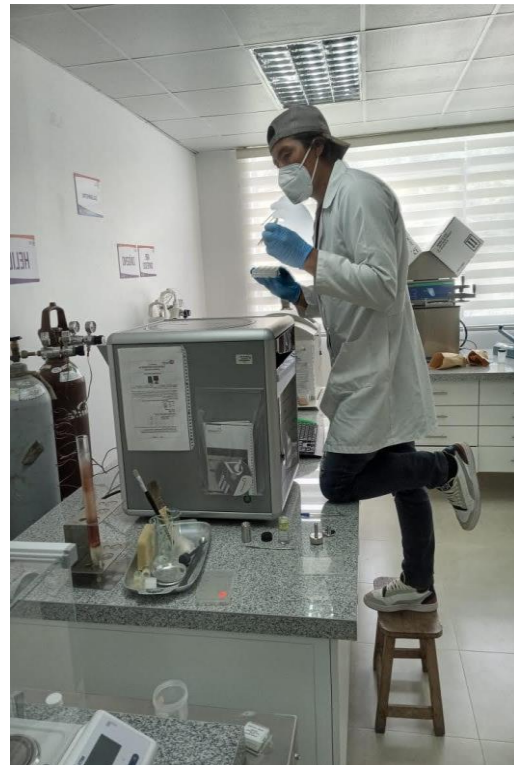
Figura 8. Muestras en mufla para determinación de contenido de cenizas.
