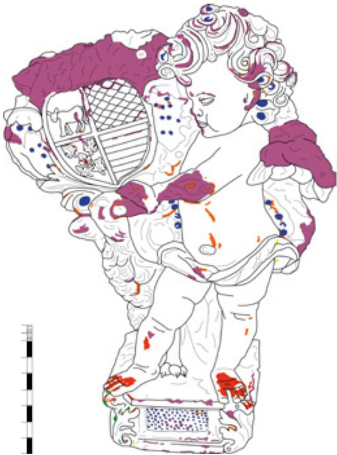
Fig. 48. Cartografía de daños correspondiente al anverso.
