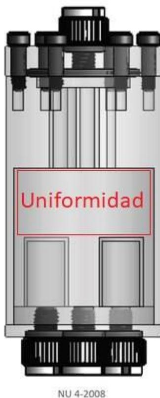
*Figura 9 – Diagrama del fantoma NEMA IQ indicando la ubicación de la región de uniformidad.*
