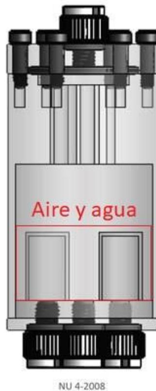
Figura 15 – Diagrama del fantoma NEMA IQ indicando la ubicación de la región del agua y el aire.
