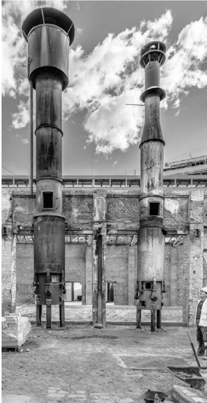
Figura 1.2.1: Hornos cubilotes para la fundición de la fábrica de Carlos Gens Autores: Frank Gómez y P. Berrocal Ruiz
