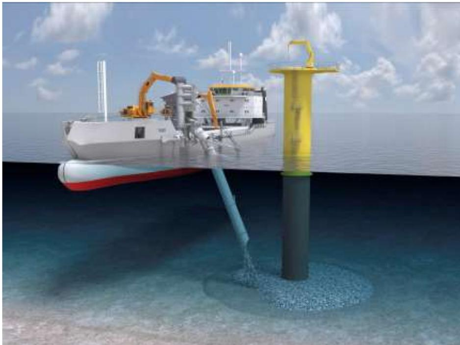
**Imagen 61. Vertido escollera para protección anti-socavación. Fuente: ScienceDirect (2017).**
