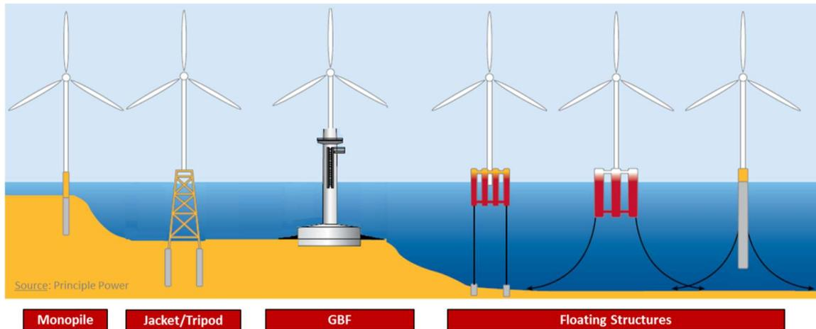
Imagen 16. Tipos de cimentación offshore. Fuente: Principle Power.
