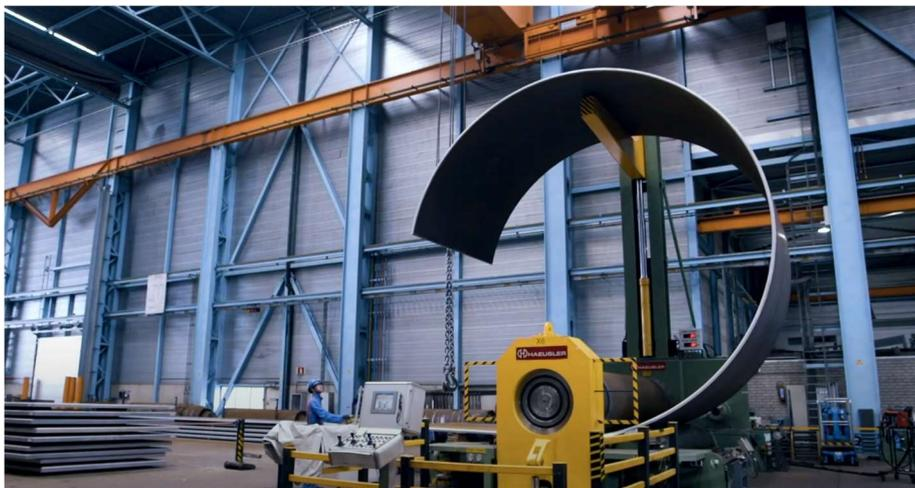
**Imagen 54. Proceso de curvado de placas para formar secciones. Fuente: Sif Group.**
