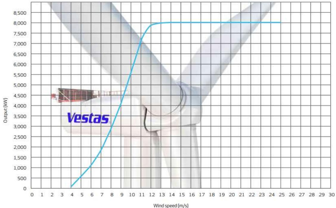
**Imagen 73. Curva de potencia V164-8.0 MW. Fuente: VESTAS (2011).**
