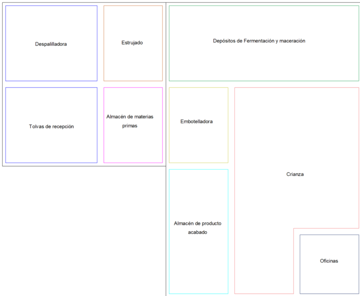
Ilustración 6-2. Distribución en planta.
