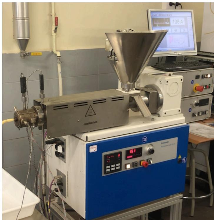
Figura 5. Equipo de extrusión
