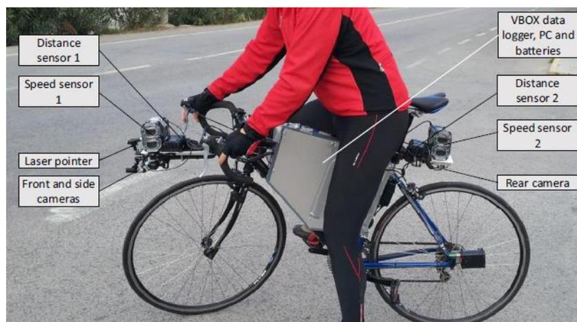
Figura 10. Bicicleta instrumentada utilizada por Llorca et al. (2017).
