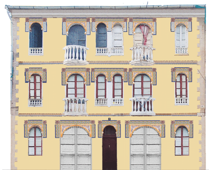
Fig.38. Representación de la fachada de la vivienda en calle Maneul Arnau 9 con la tonalidad de color original. Elaboración propia
