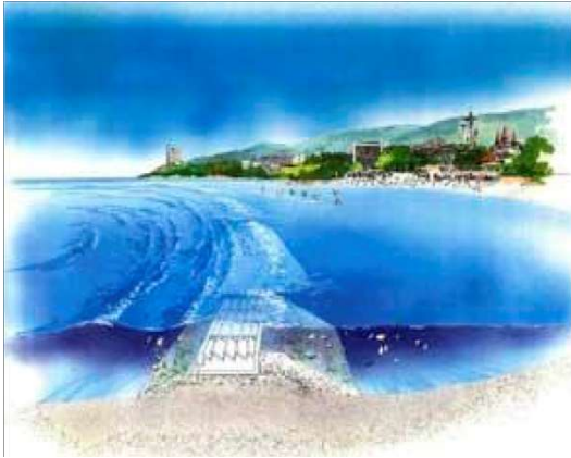
F40. Izquierda: Dibujo del funcionamiento de un arrecife sumergido. Derecha: Fotografía aérea de un arrecife sumergido. Fuente: Guía metodológica para la instalación de arrecifes artificiales. 23
