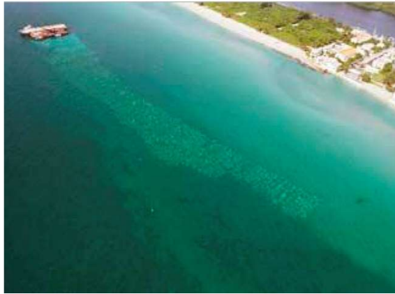
F40. Izquierda: Dibujo del funcionamiento de un arrecife sumergido. Derecha: Fotografía aérea de un arrecife sumergido. Fuente: Guía metodológica para la instalación de arrecifes artificiales. 23
