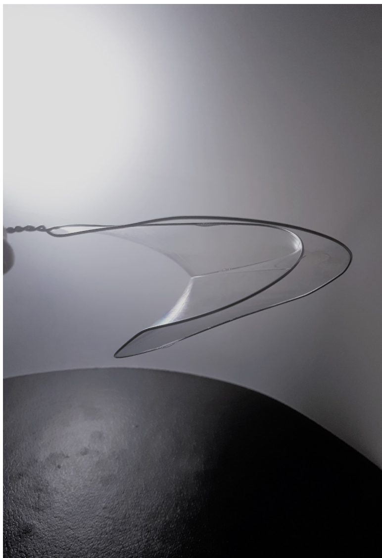
Imagen 18. Imagen propia. Autogeneración de formas con bordes rígidos de doble curvatura
