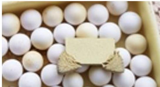
**Figura 5.14.** Aleación Ti-35Nb-6Mo tras 24 horas de oxidación a 700°C
