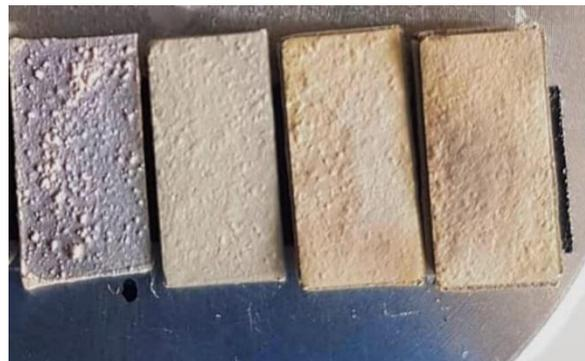
**Figura 5.18.** Aleación Ti-35Nb-6Mo tras 8,24,48 y 72 horas de oxidación a  $800^\circ\text{C}$  respectivamente.
