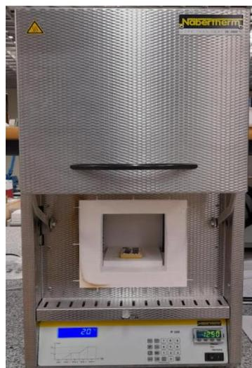
**Figura 4.7.** Horno empleado para la oxidación.
