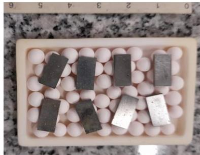
**Figura 4.6.** Disposición de las muestras en la placa cerámica dentro del horno
