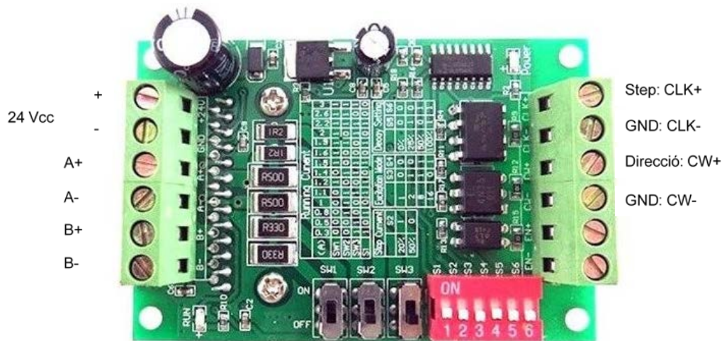
Figura 48. Connexions GND (CW- i CLK-), direcció (CW+) i step (CLK+) del TB6560, alimentació de 24 Vcc i connexions A-, A+, B- i B+ dels motors pas a pas Nema (Elaboració pròpia)
