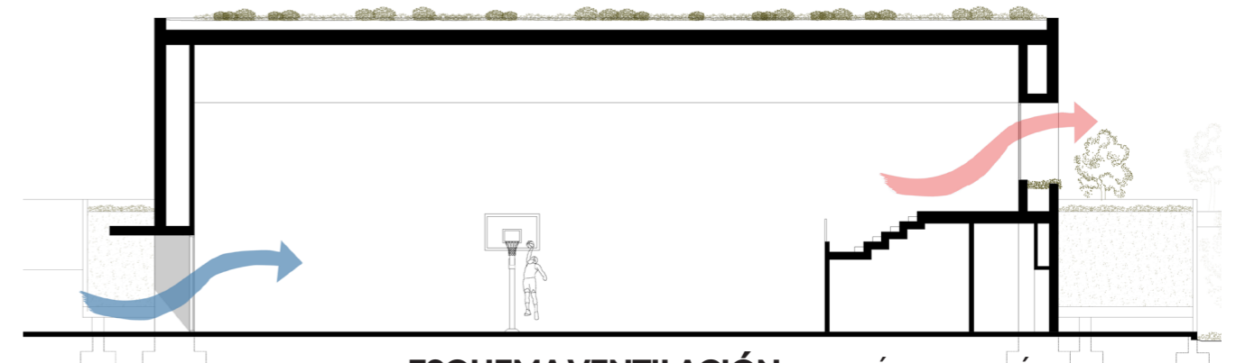
ESQUEMA VENTILACIÓN. SECCIÓN PABELLÓN DEPORTIVO
